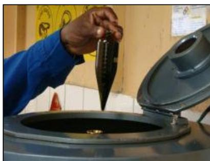
**Fig. 9: Determinación de % BSW**
