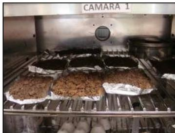
**Fig. 5: Secado de suelos mediante estufa de convección mecánica**
