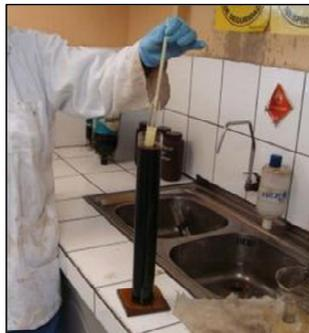
**Fig. 8: Determinación de °API**
