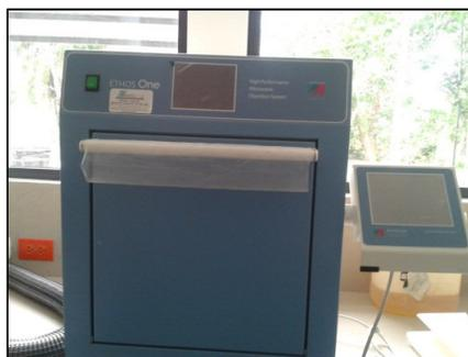
**Fig. 6: Digestión microondas para metales**
