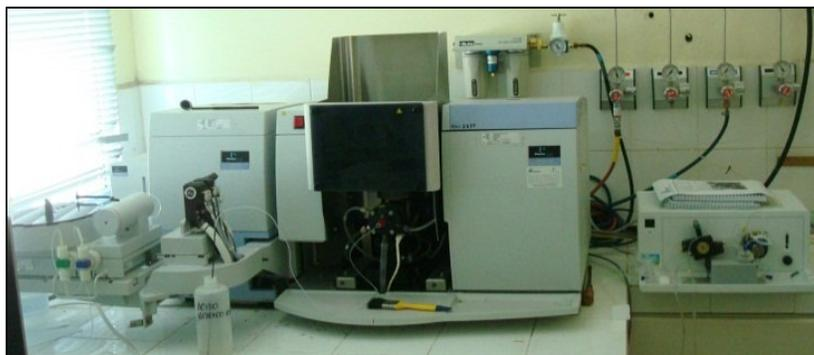
**Fig. 7: Determinación de metales equipo Perkin Elmer AA-400**
