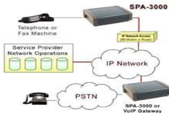
Figura 2.15 Descripción de la Conexión del SPA 3000
