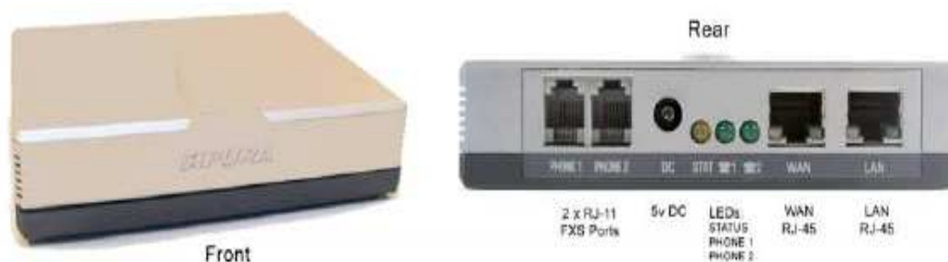
Figura 3.3 Descripción del Adaptador Sipura 2100
