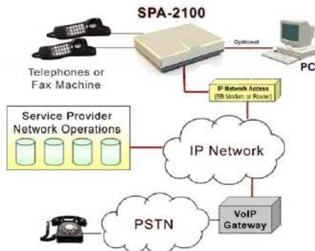
Figura 2.13 Descripción de la Conexión del SPA 2100
