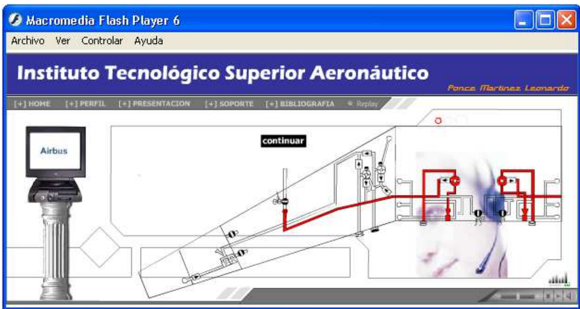
Fig. 3.43 Presentación del Sistema de Alimentación de Combustible al Motor Por las Bombas del Tanque Central.
