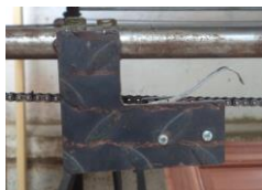
Figura 27.: Micros switch ubicados longitudinales.
