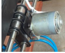
Figura 24.: Motor para el movimiento transversal.
