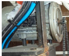
Figura 25.: Motor para el movimiento longitudinal.
