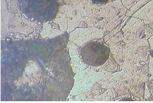
Fig. 1.7 – Microestructura de la fundición observada mediante microscopio 400x 10
