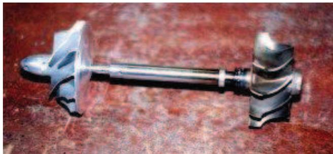
**Figura 2.2:** Eje compresor – turbina
