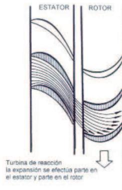
**Figura 2.6:** Turbina de reacción
