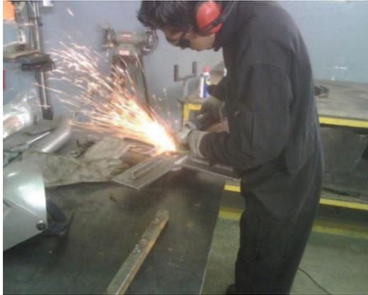
**Figura 3.8:** Proceso de Esmerilado del Extractor
