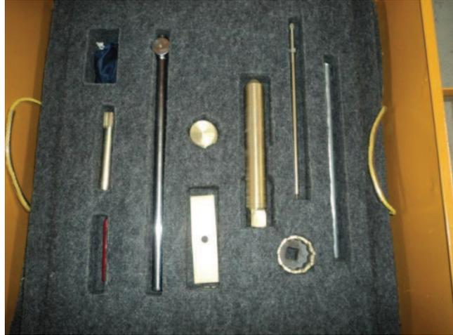
Caja de transporte, Extractor del Disco de Turbina:
