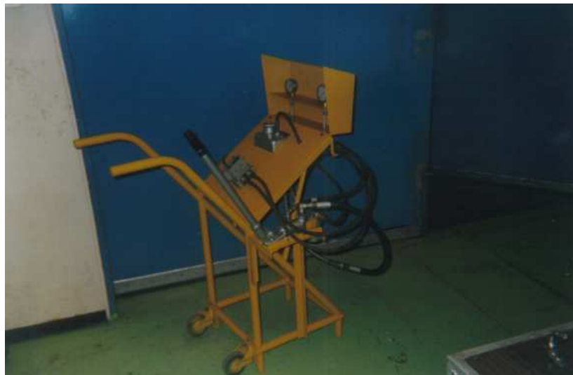
Figura 4.1. Banco hidráulico para comprobar accesorios y componentes hidráulicos con alta y baja presión (vista lateral derecha)
