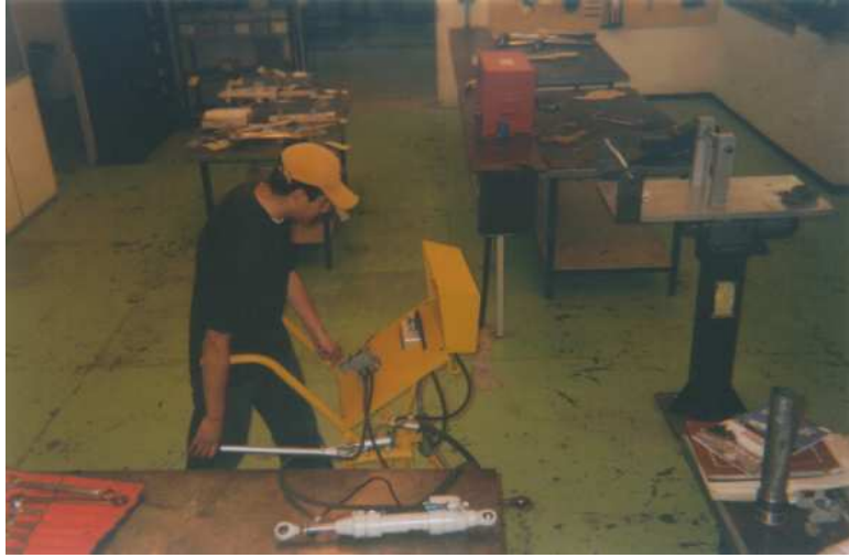
Figura 4.4. Comprobación del funcionamiento de un cilindro actuador de doble efecto
