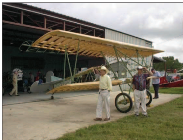
Figura 2.25: Fuselaje sin recubrimiento de un Fokker DVII, fuselaje en tubo de acero y ala en madera, recubrimiento de tela.
