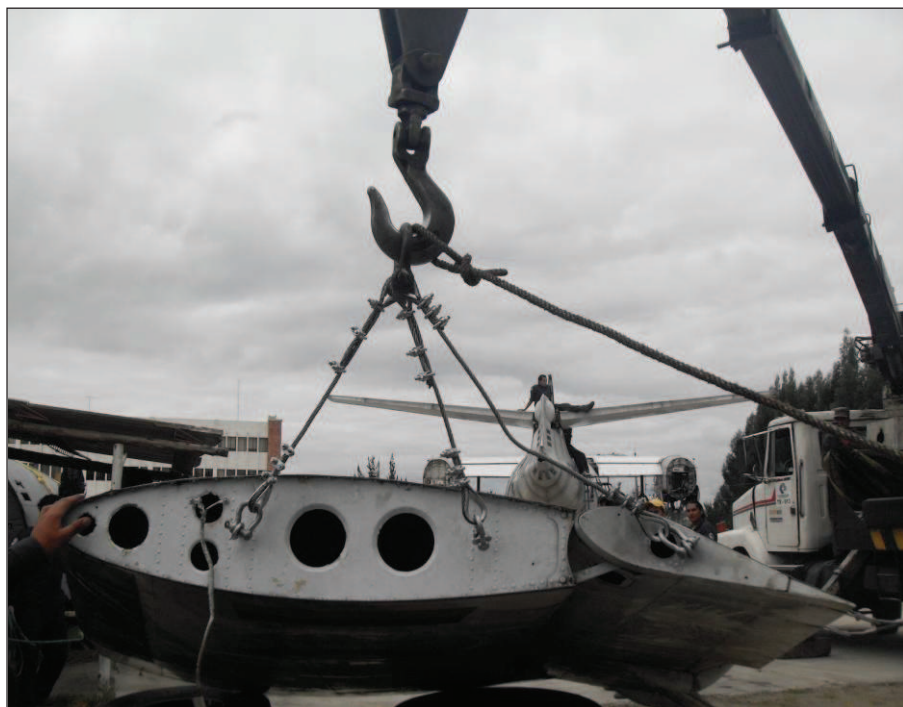
Figura B.2: Desmontaje del estabilizador vertical. Fuente: Investigación de campo.
