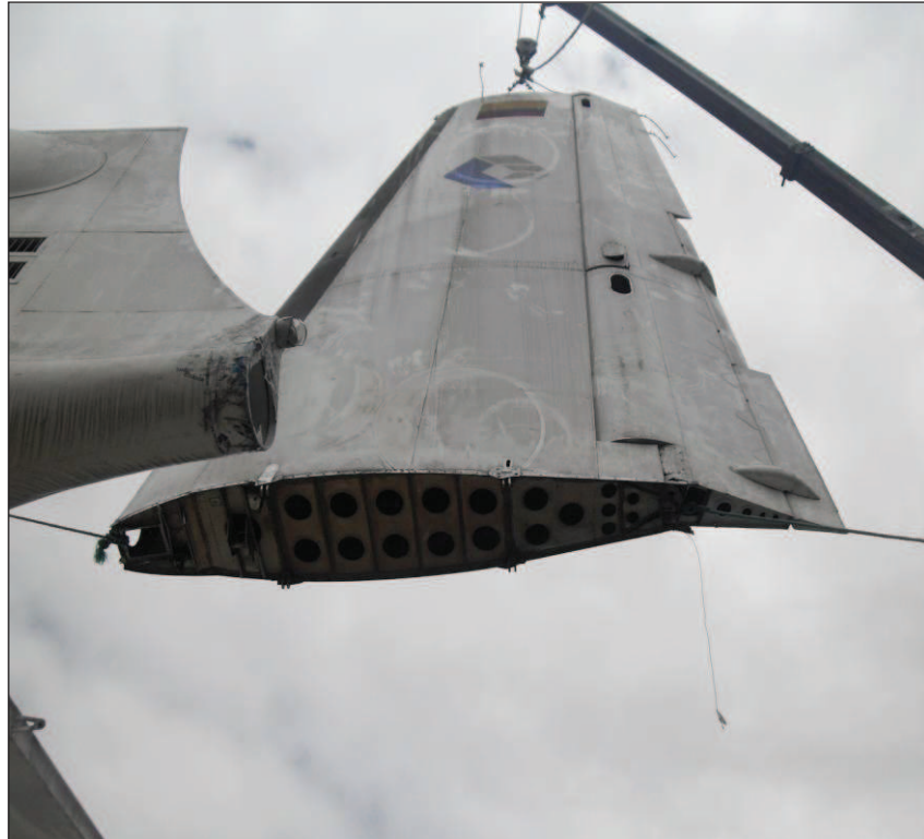
Figura 3.27: desmontaje del estabilizador vertical. Fuente: investigación de campo.
