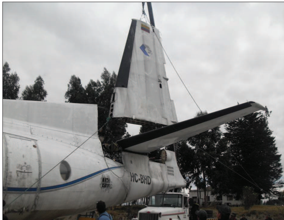
Figura B.4: Desmontaje del estabilizador vertical. Fuente: Investigación de campo.
