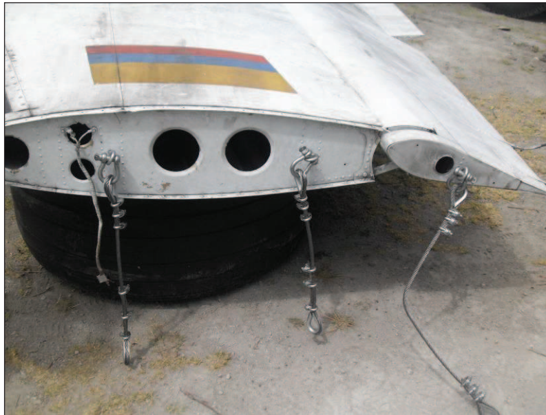
Figura 3.23: puntos de sujeción de la eslinga con el estabilizador vertical. Fuente: investigación de campo.
