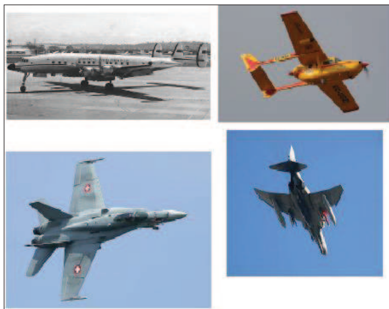
Figura 2.22: cola en H, cola doble fuselaje, doble cola, cola en Y. Fuente: http://ivao.es/uploads/8697689eec233abb95cd0b31ab6e8dec.pdf
