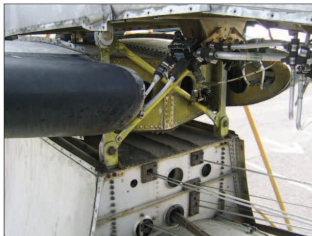
Figura 3.22: Cañerías de succión, presión y distribuidor de la válvula solenoide.
