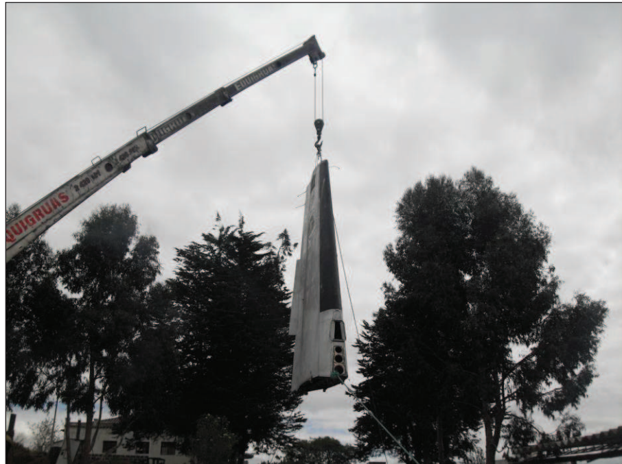
Figura B.3: Desmontaje del estabilizador vertical. Fuente: Investigación de campo.
