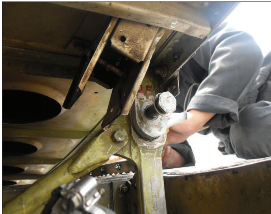
Figura 3.26: remoción de los pernos de sujeción del estabilizador vertical. Fuente: investigación de campo.
