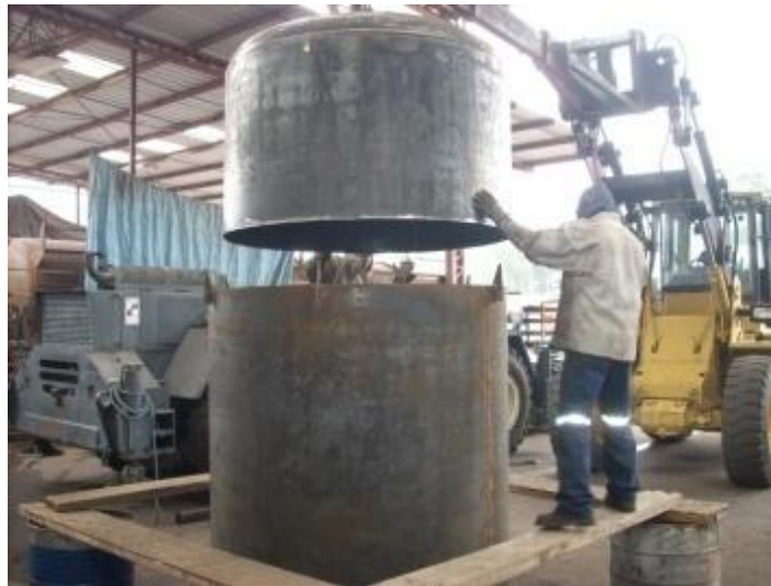
Fotografía 8: Posicionamiento Unión Cilindro-Cilindro
