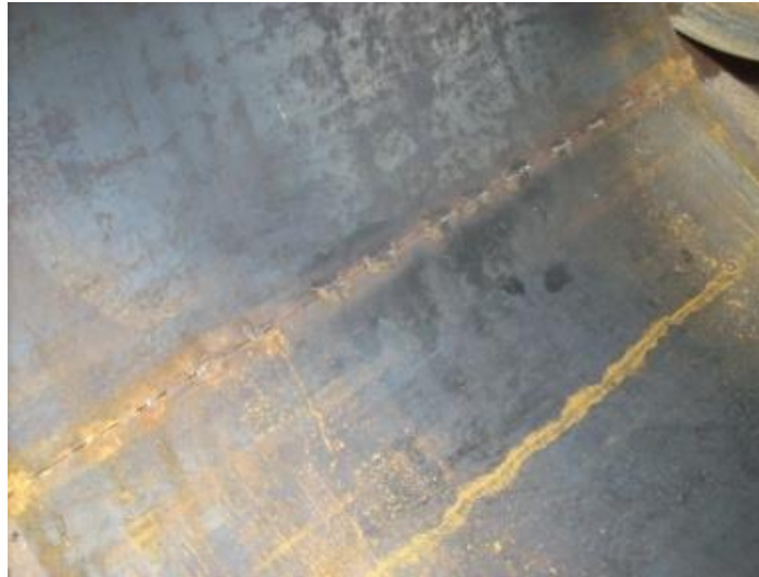
Fotografía 1: Plancha Rolada y Punteada con Soldadura 6010
