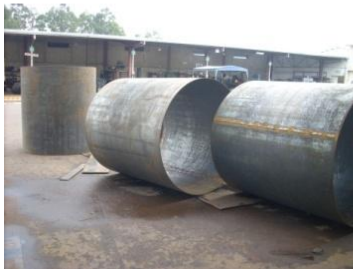
Fotografía 2: Planchas Roladas y Punteadas
