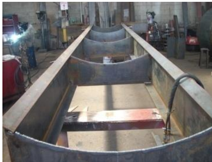
Fotografía 20: Base del Chasis Terminada para Unir al Tanque
