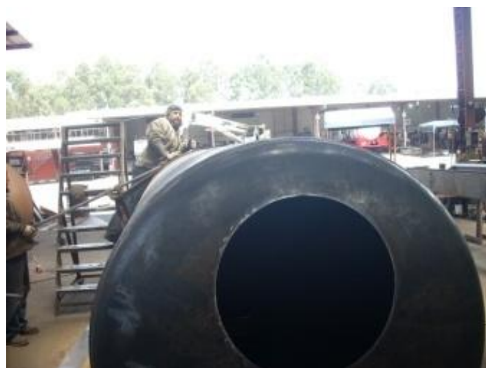
Fotografía 16: Hoyo para Manhole
