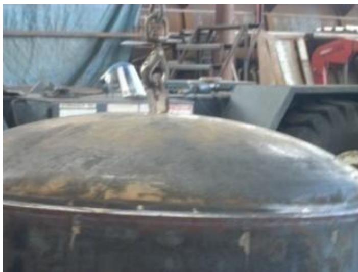
Fotografía 6: Soldadora Biselada Unión Tapa-Cilindro
