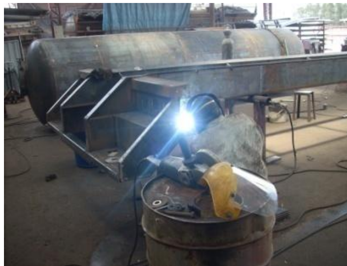
Fotografía 32: Soldadura Construcción del Chasis
