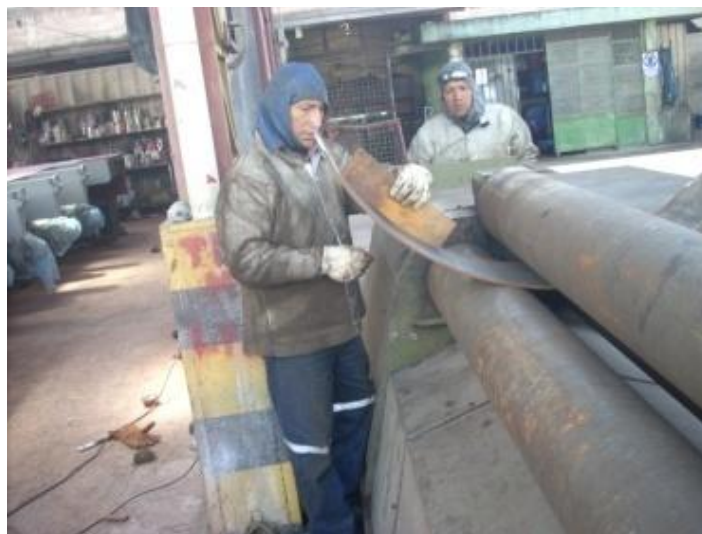
Fotografía 18: Rolado de Refuerzo para Base del Cuerpo del Tanque Fuente: Propia
