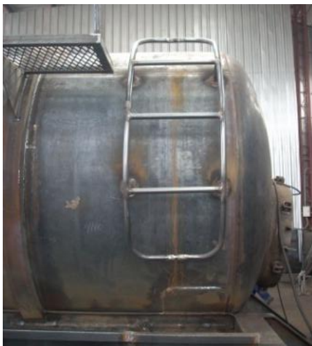
Fotografía 39: Escalera Soldada al Tanque
