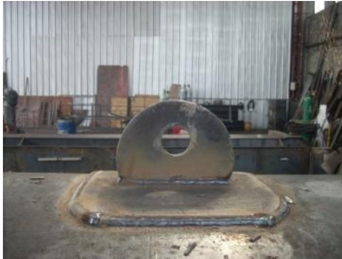
Fotografía 33: Oreja y Base Soldados en el Tanque
