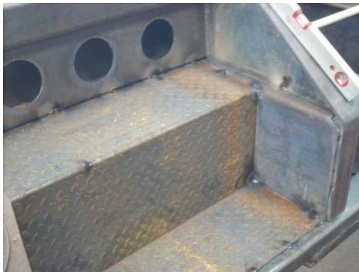
Fotografía 25: Gradas Soldadas al Chasis
