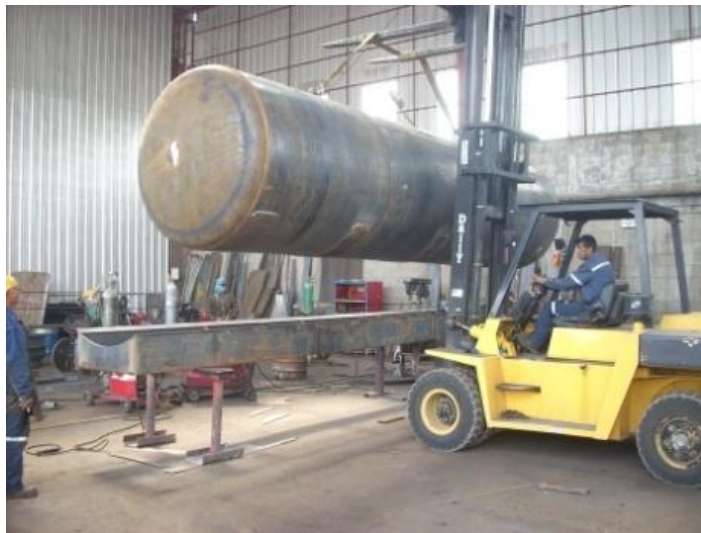
Fotografía 34: Unión Tanque-Base por medio de una Cargadora
