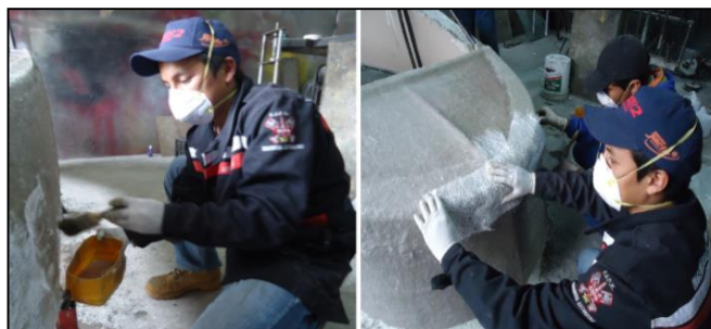
Gráfica 106 Proceso de colocación de la fibra de vidrio. Autores: Cunalata W, Terán J.
