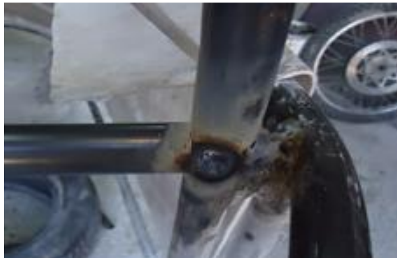
Gráfica 30 Punteado de soldadura. Fuente: Cunalata W, Terán J.
