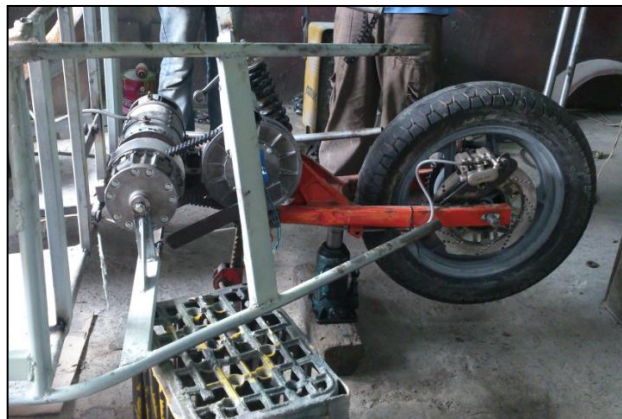
Gráfica 97 Bases para el tren motriz. Autores: Cunalata W, Terán J.
