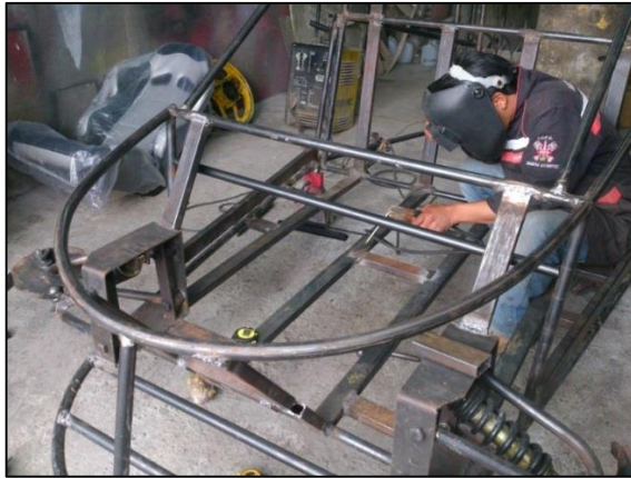
Gráfica 98 Proceso de suelda del bastidor. Autores: Cunalata W, Terán J.
