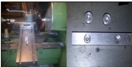
Figura 8. Desbaste de material para creación de acoples.
