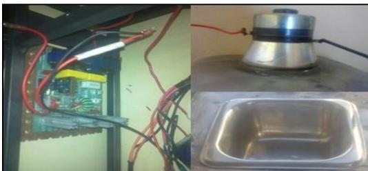
**Figura 7.3.2.** Componentes de la tina ultrasónica.
