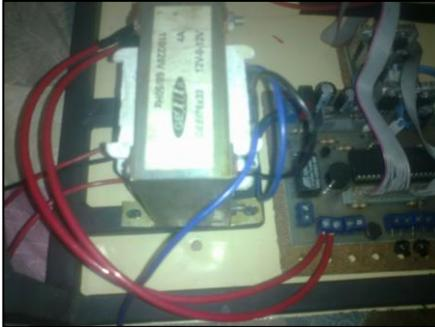
**Figura 7.3.1.** Conexión del transformador GEEI76x33.
