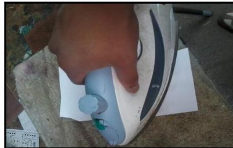
Figura 5.2. Proceso de transferencia del circuito mediante calor.
