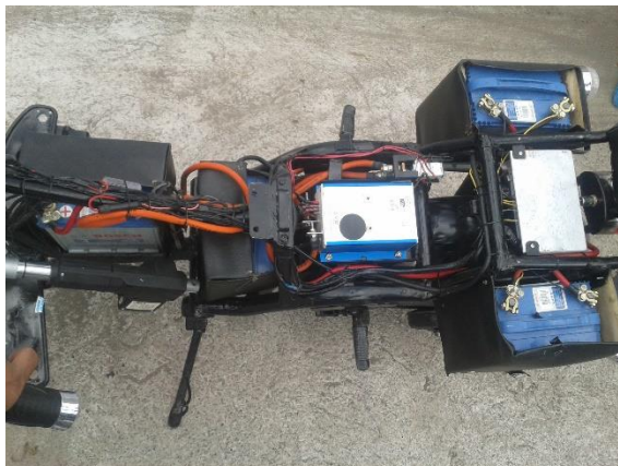
Figura 5.1 Ubicación de los elementos del sistema eléctrico motriz Fuente: Los Autores
