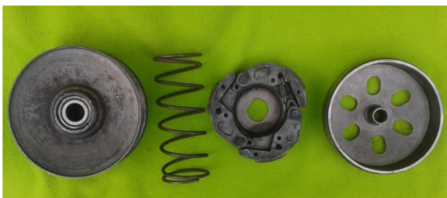
Figura 3.12 Centrífugo trasero modificado
