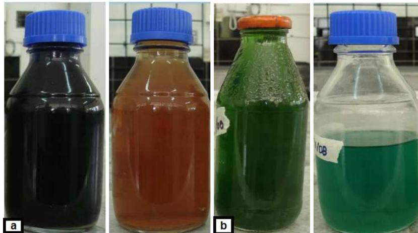
Figura 3. 1: Muestras obtenidas del proceso de lavado de una industria textil, que cambiaron su coloración después de dos semanas de almacenamiento a) inóculo 3 y b) inóculo 4. A la derecha de cada figura se observa la muestra con el color original, a la izquierda la muestra que cambio de coloración.
