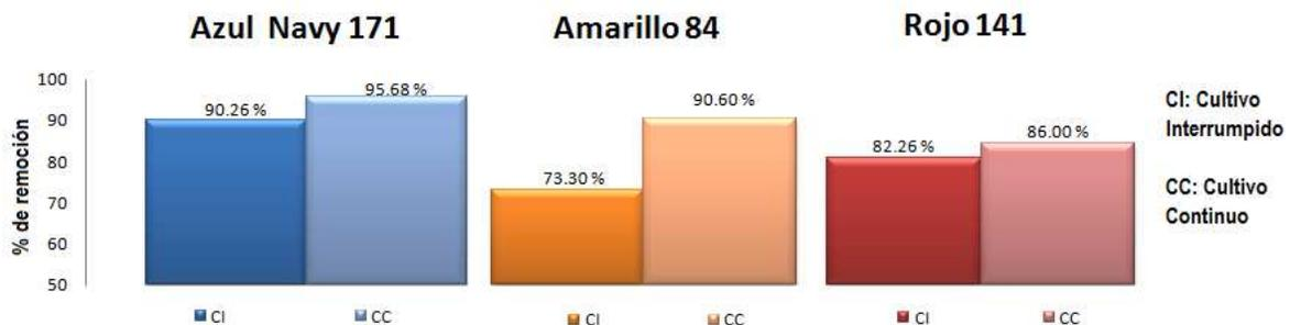
Figura 3. 6: Comparación de porcentajes de remoción del colorante Azul Navy, Amarillo 84 y Rojo 141, en “Cultivo interrumpido” (abierto cada tres días para extracción de muestras) y en “Cultivo continuo” (incubado sin apertura de la cámara gas pack durante el período de incubación).
