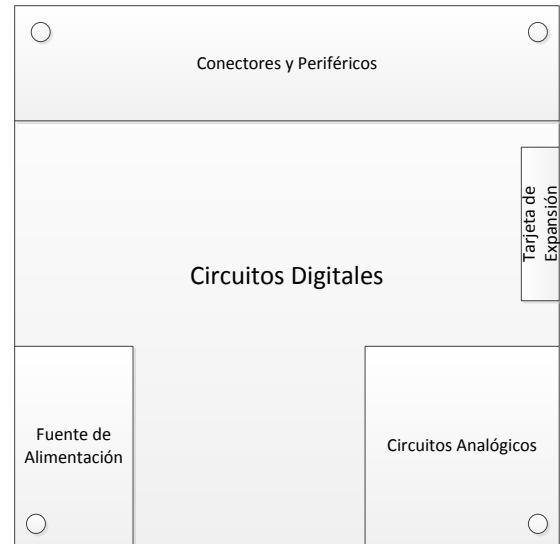
Figura 3. División de la tarjeta principal
