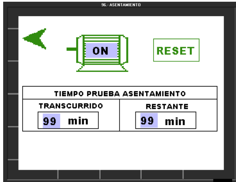
Figura 2.48. Pantalla asentamiento escobillas.
