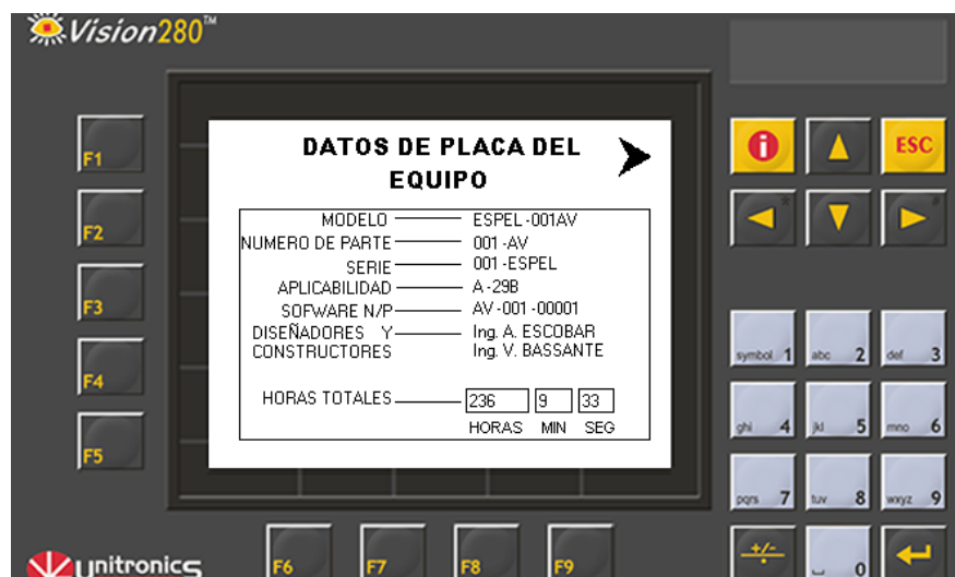
Figura 3.13. Pantalla datos de placa del equipo implementada.
