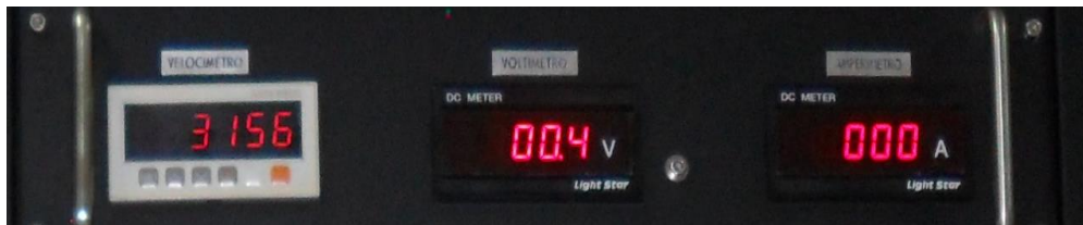
Figura 3.6. Módulo de instrumentos en funcionamiento a 3156 RPM.
