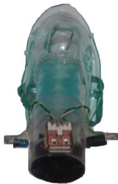
Figura 3.10: Mascarilla acoplada al Sensor de turbina e infrarrojo. Elaborado por: Gómez O, Silva I.
