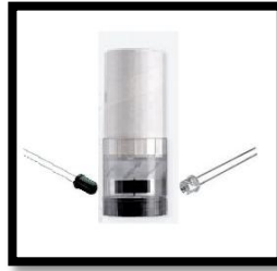
Figura 2.34: El sensor fotodiodo detecta el movimiento de la turbina. Elaborado por: Gómez O, Silva I.
