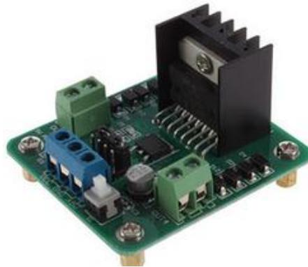
**Figura 2.23. Módulo puente H L298N de 2A**
