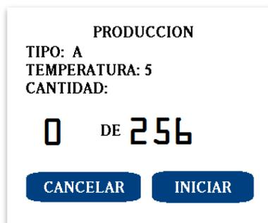
La pantalla producción Figura 3.28 mostrará la temperatura, la cantidad de helados en proceso y dos botones: **INICIAR**, que arranca el proceso y **CANCELAR** que suspenderá la producción y mostrará la pantalla inicial Figura 3.25
