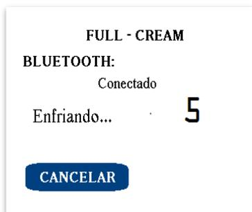
La pantalla Bluetooth Figura 3.29 mostrará el estado de la conexión inalámbrica, la temperatura en caso de estar activado el sistema de enfriamiento y el botón **CANCELAR** que regresará a la pantalla inicial Figura 3.25.
