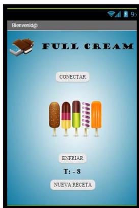
La interfaz gráfica de la aplicación en su pantalla principal Figura 3.30, contará con el botón de conexión y desconexión al controlador, un botón para activar el sistema de enfriamiento, y un botón para pasar a la pantalla RECETA Figura 3.31; así también mostrará el valor de la temperatura entre los botones enfriar y nueva receta.
