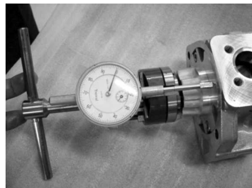
Figura 7. Instalación del indicador de cuadrante en el medidor.
