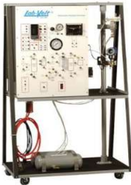
Figura 1. 22. Estación de Proceso de Presión. [20]
