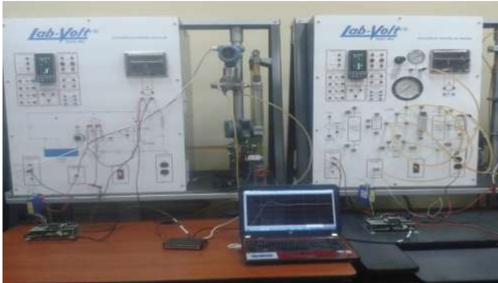
Figura 3. 9. Controlador De Presión y Flujo integrados en una red Ethernet
