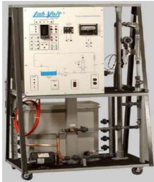
Figura 1. 21. Estación de Proceso de Flujo. [20]
