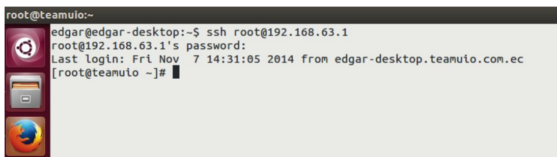
Figura 27. Prueba de acceso vía SSH, consola, desde un host dentro de la red.
