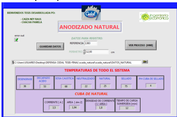
Figura 18 Pantalla principal del sistema de monitoreo y de adquisición de datos SCADA
