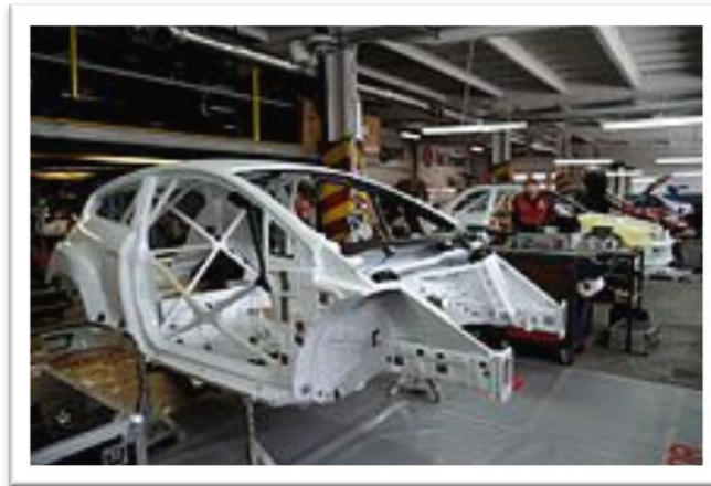
Figura 2.7. Chasis de un Ford Fiesta S2000 con el arco de seguridad preparado su montaje.
