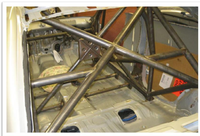
Figura 2.12. Soldadura de la jaula.
