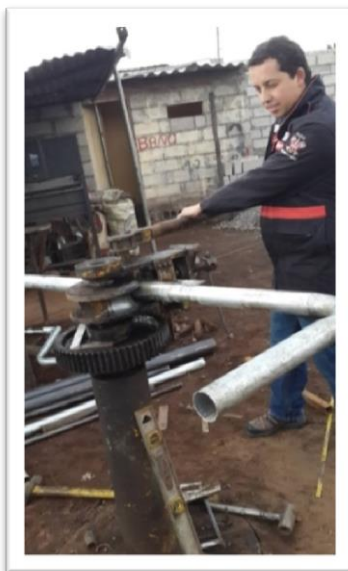
Figura 3.16. Doblado de tubos
