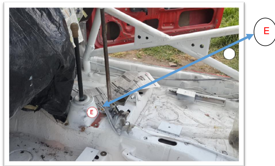
Figura 2.16. Palanca de accionamiento del sistema de extintor marcado con una letra E de color rojo en un círculo de color blanco.
