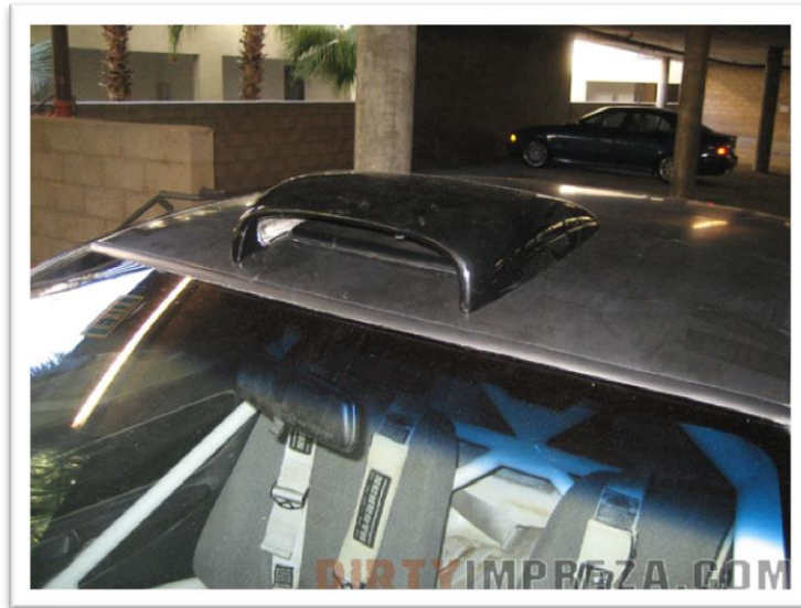
Figura 2.17. Toma de aire en el techo.
