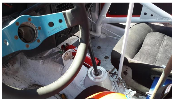
Figura 3.34 Torreta de marchas terminada.
