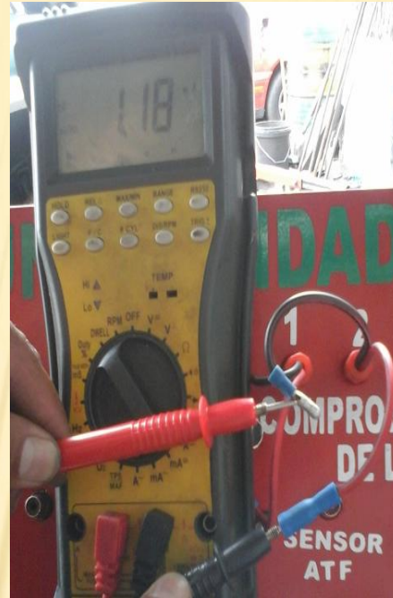
Puntos de medición Solenoides 2
