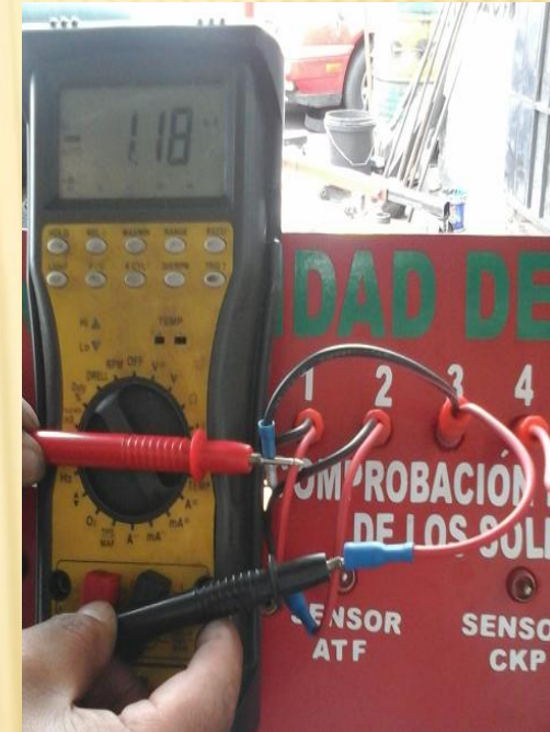
Puntos de medición Solenoides 3
