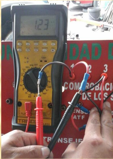
Puntos de medición Solenoides 1
