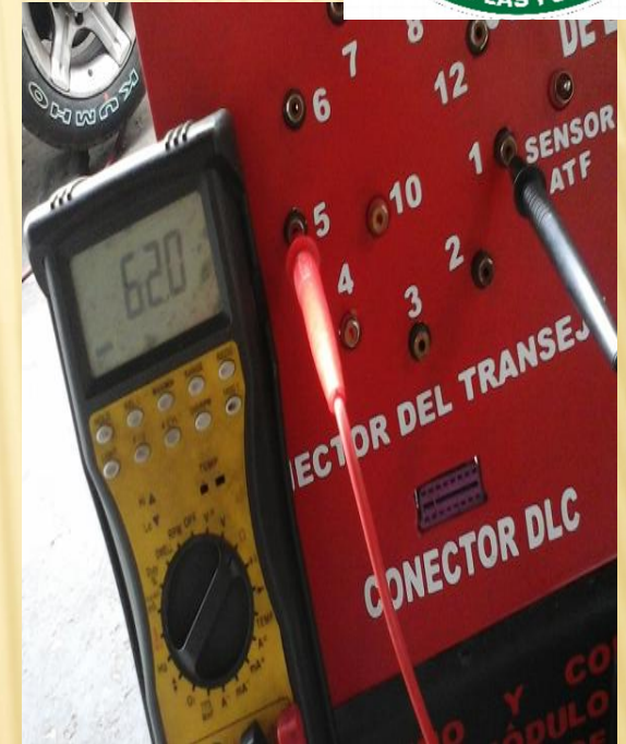
Comprobación de resistencia solenoide 3
