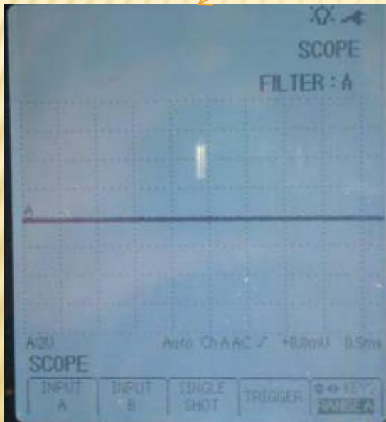
Corte de señal CAN HIGH
