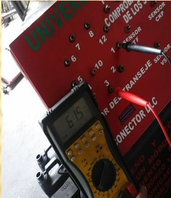
Comprobación de resistencia solenoide 1
