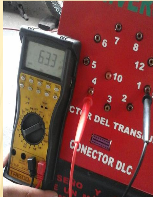
Comprobación de resistencia solenoide 2
