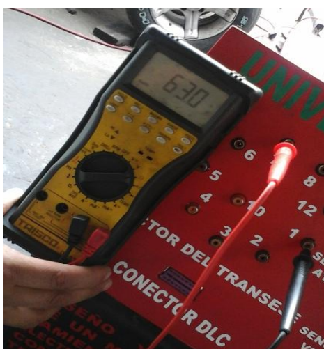
Figura 4.19. Comprobación de resistencia solenoide 4
