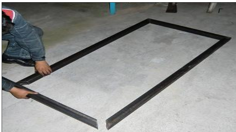
Figura 3.10: Unión primaria de la base del bastidor
