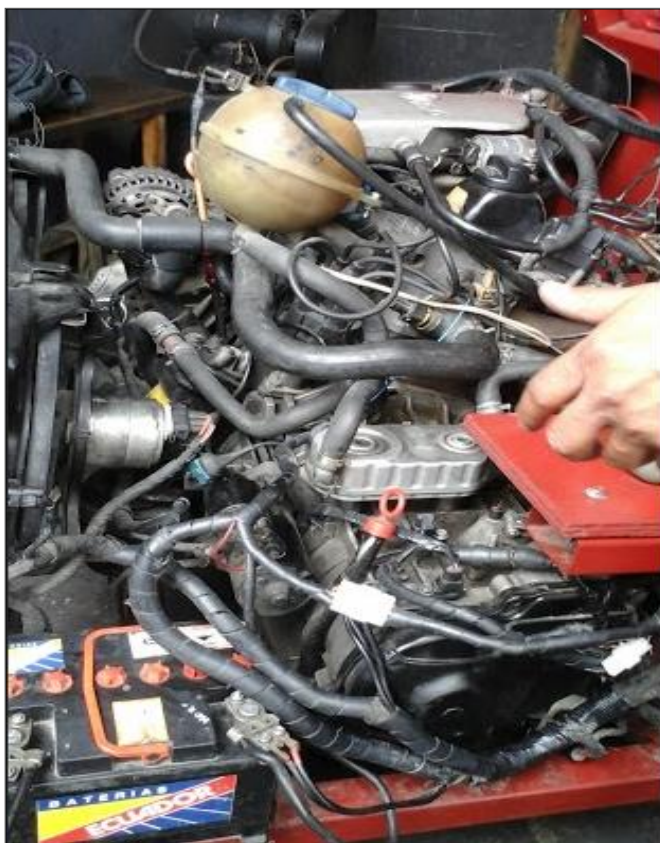
Figura 3.29. Montaje de la transmisión y el motor
