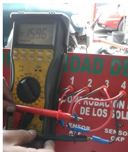
Figura 4.23. Puntos de medición Solenoide 4
