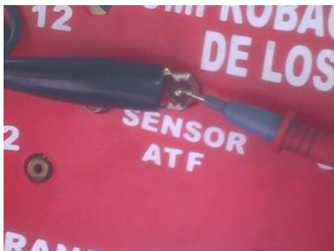
Figura 4.4. Puntos de conexión del sensor de temperatura
