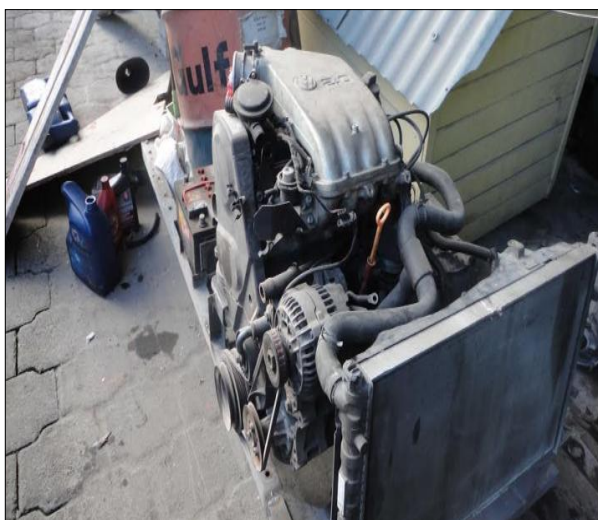
Figura 3.22. Motor montado en la estructura del módulo.
