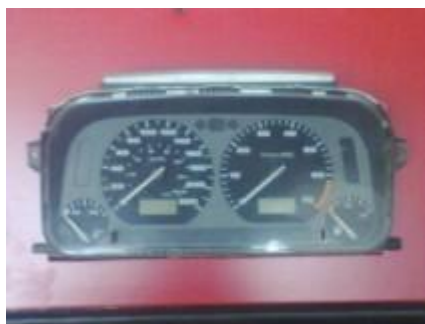
Figura 3.17: Tablero indicador del motor
