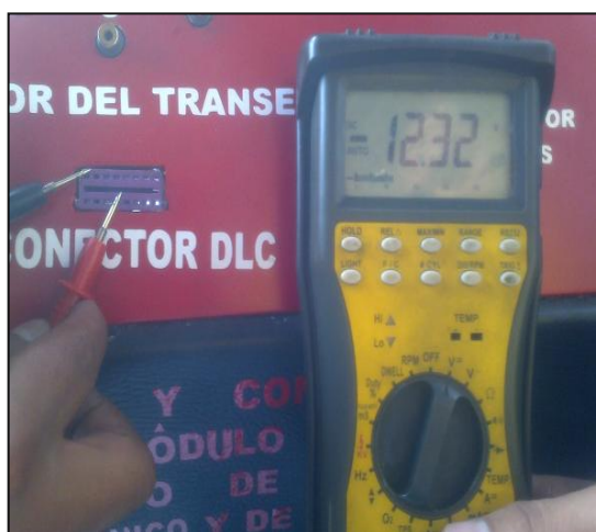
Figura 4.24. Valor de alimentación del conector DLC, pin 15.
