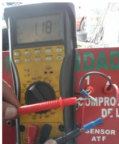
Figura 4.21. Puntos de medición Solenoide 2
