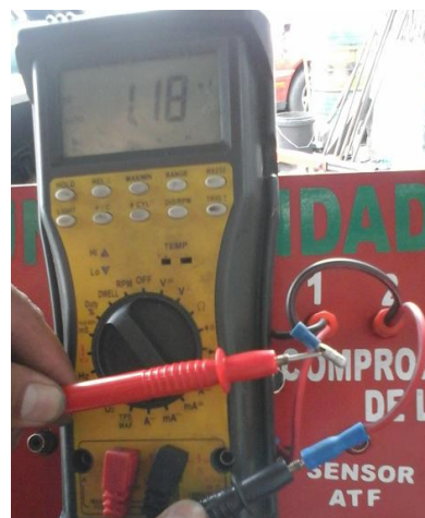
Figura 4.22. Puntos de medición Solenoide 2
