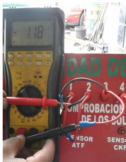
Figura 4.23. Puntos de medición Solenoide 3
