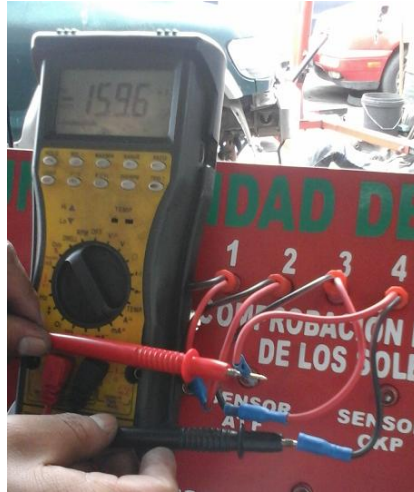
Figura 4.24. Puntos de medición Solenoide 4
