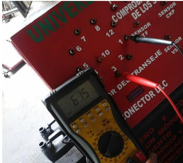
Figura. 17. Comprobación de resistencia solenoide 1
