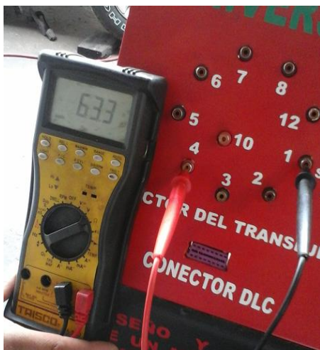
Figura 4.17. Comprobación de resistencia solenoide 2
