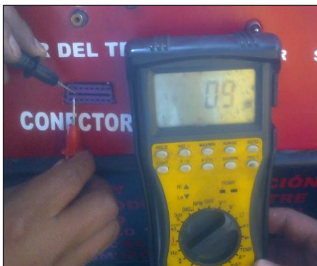
Figura 4.25. Valor de resistencia de la red.
