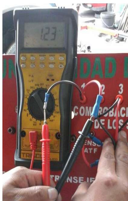
Figura 4.20. Puntos de medición Solenoide 1
