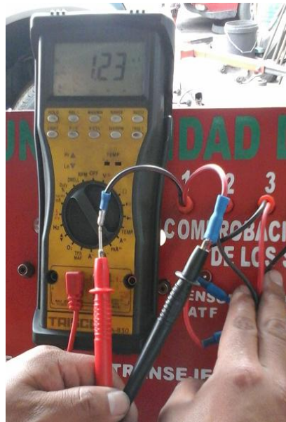
Figura 4.21. Puntos de medición Solenoide 1
