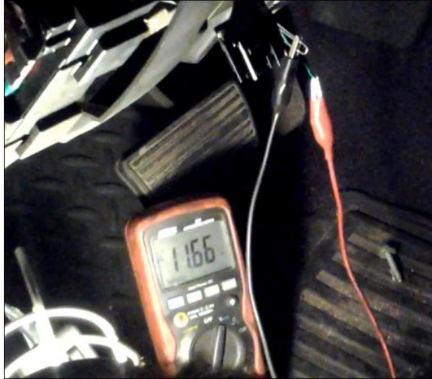
Figura 26. Valor de alimentación del conector DLC, pin 17.
