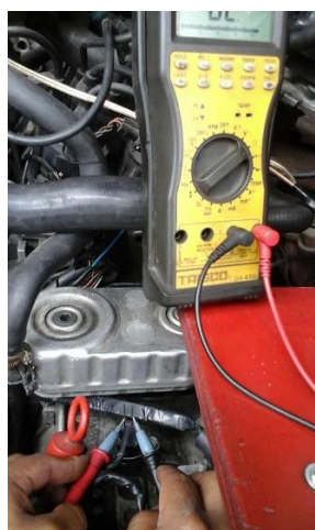
Figura.4.8 Puntos de conexión del sensor OSS
