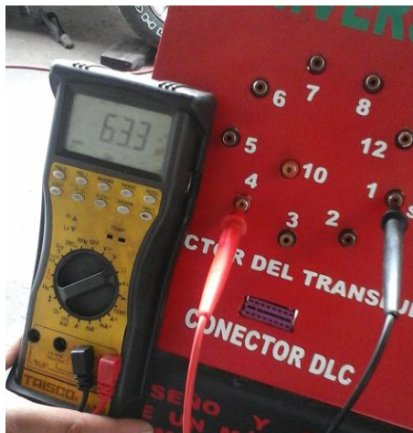
Figura 4.18. Comprobación de resistencia solenoide 2
