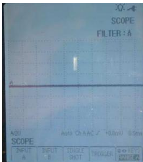
Figura 4.30. Corte de señal CAN HIGH
