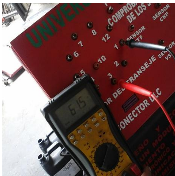
Figura. 4.16. Comprobación de resistencia solenoide 1
