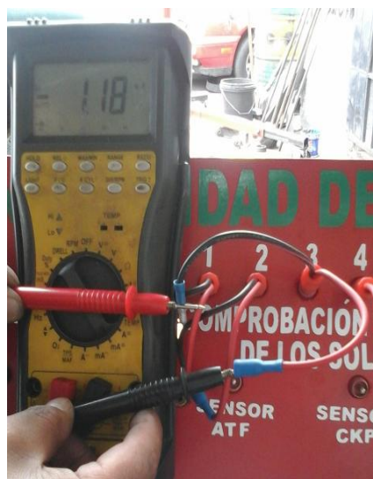
Figura 4.22. Puntos de medición Solenoide 3
