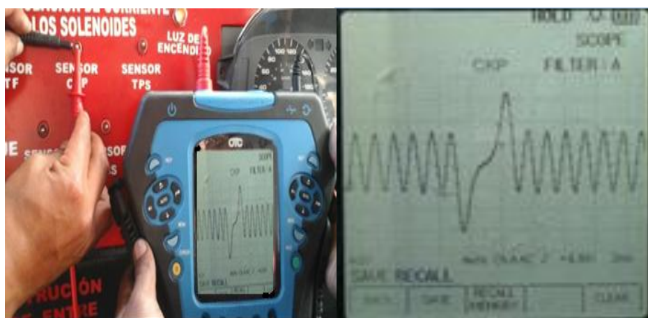
Figura 4.12: Punto de conexión, Oscilograma sensor CKP
