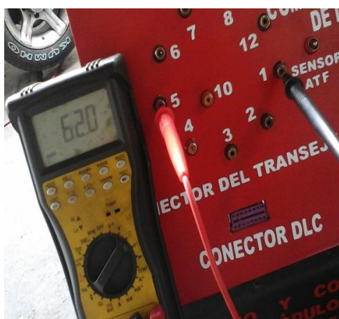
Figura 4.18. Comprobación de resistencia solenoide 3
