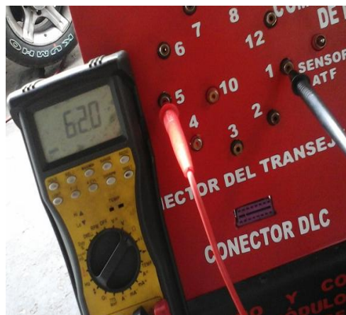
Figura 4.18. Comprobación de resistencia solenoide 2
