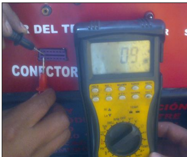
Figura 27. Valor de resistencia de la red.
