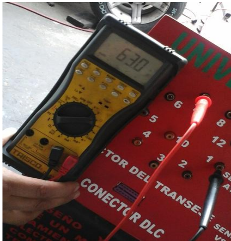
Figura 4.20. Comprobación de resistencia solenoide 4
