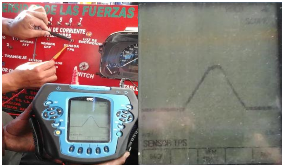
Figura 4.14: Punto de conexión, Oscilograma sensor TPS
