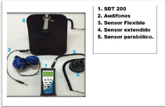
**Figura 2.- Detector ultrasónico.**
