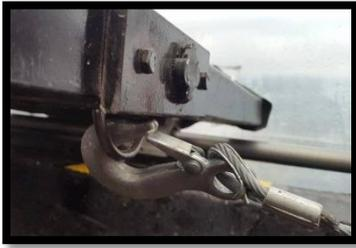
Fig. 22 SUJECIÓN DEL TRINEO MÓVIL
