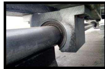
Fig. 21 COLOCACIÓN DE RODAMIENTOS AL TRINEO
