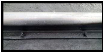
Fig. 17 SUJECIÓN DEL EJE A LA BASE
