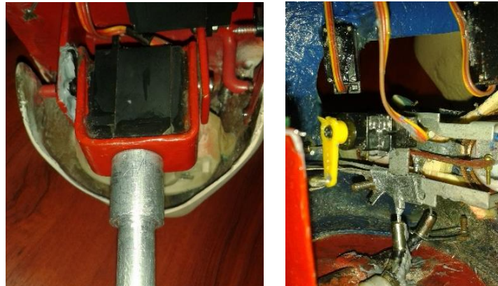
Figura 3.13 Encajamiento del Servo del Cuello y de los Micro Servo.
