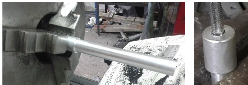
Figura 3.6 Mecanizado del Eje Principal del Robot.
