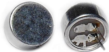
Figura 1.20 Micrófono – Transductores Electroacústico de Condensador.
