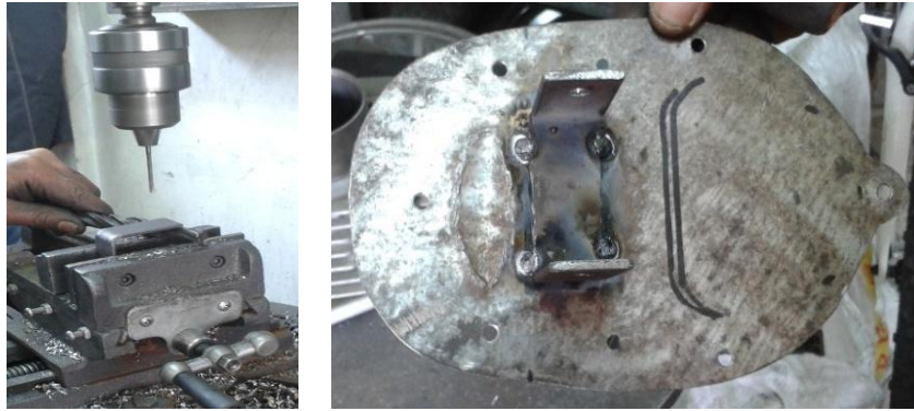
Figura 3.8 Construcción del Acople de Acero y de la Base Central del Robot.
