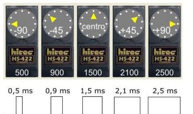
Figura 1.18 Funcionamiento de un Servomotor (HS-422).
