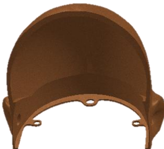
Figura 2.7 Diseño de la Región Craneal del Rostro Robótico.
