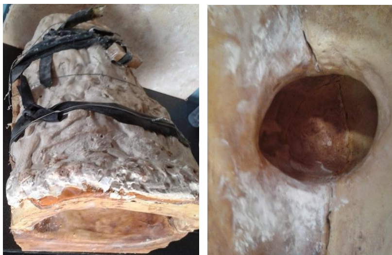
Figura 3.19 Elaboración de Moldes al Vacío para la Máscara del Rostro Robótico.
