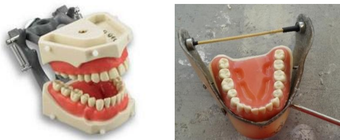
Figura 3.5 Inserción de la Dentadura en el Maxilar Inferior del Robot.
