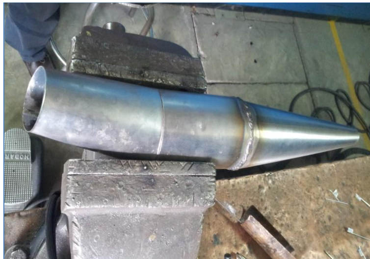
Figura 4. 21 Unión mediante suelda de las partes del TUNED PIPE
