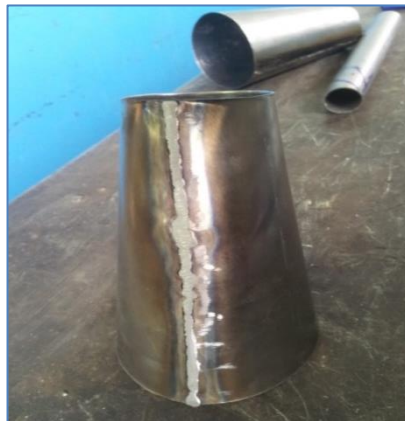
Figura 4. 23 Cono de TUNED PIPE limpiado residuos
