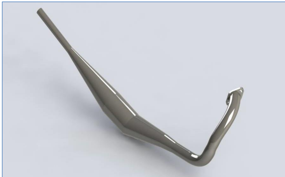
Figura 3. 13: Vista Isométrica de TUNED PIPE
