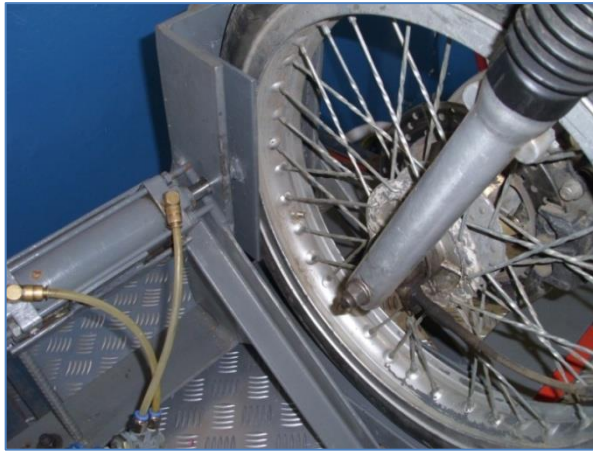
Figura 5. 5 Sujeción de llanta delantera para equilibrio y control de motocicleta
