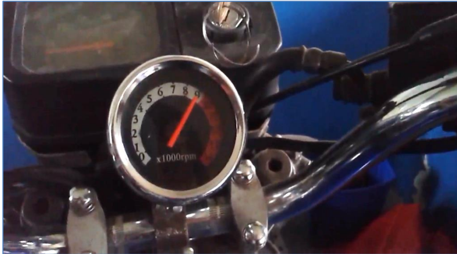
Figura 5. 15 Verificación de no exceder los límites de RPM
