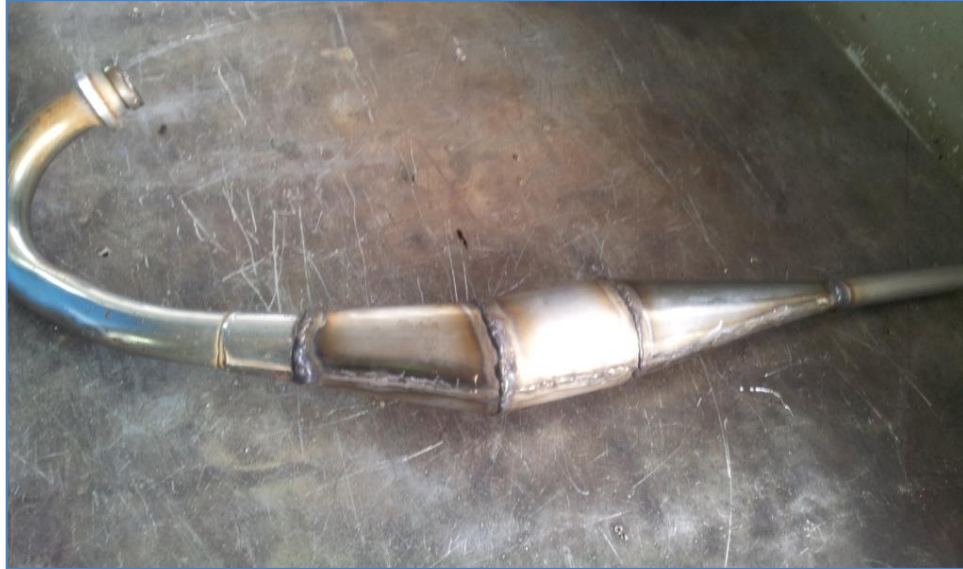
Figura 4. 24 TUNED PIPE sin residuos de soldadura
