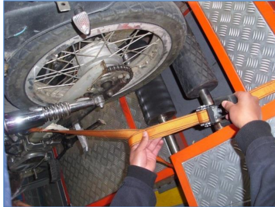
Figura 5. 7 Sujeción de la motocicleta con el tiedown
