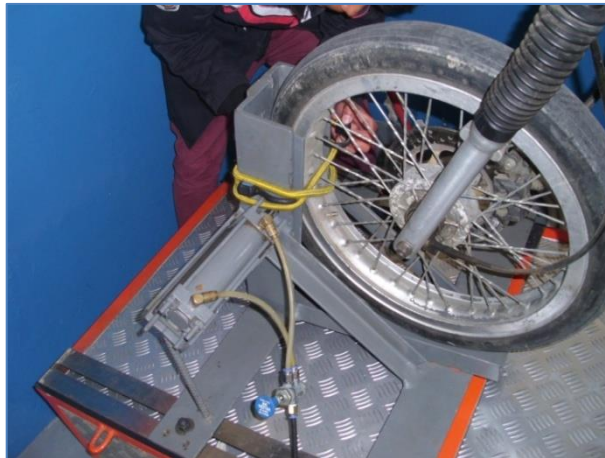
Figura 5. 6 Aseguramiento de la llanta delantera
