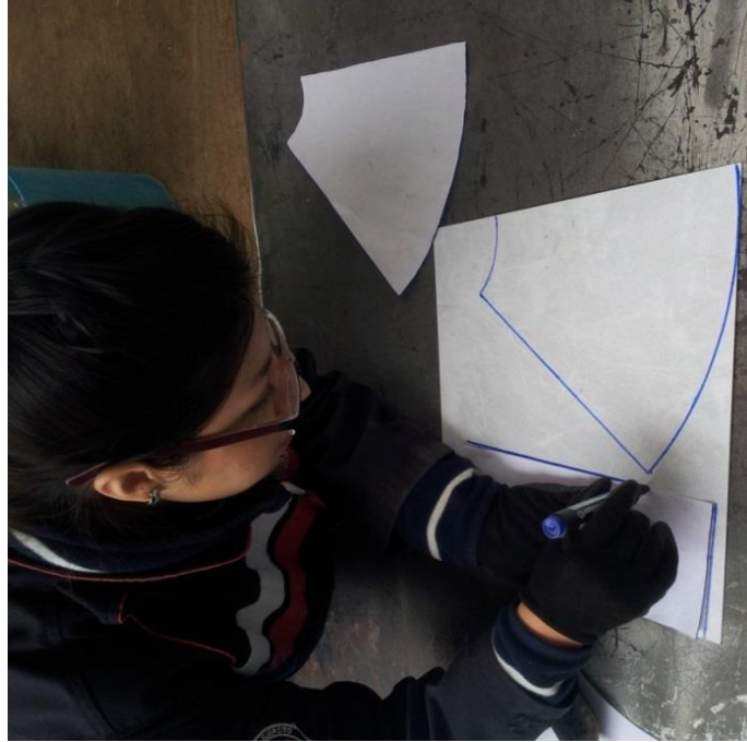
Figura 4. 9 Trazado base para TUNED PIPE en Acero inoxidable
