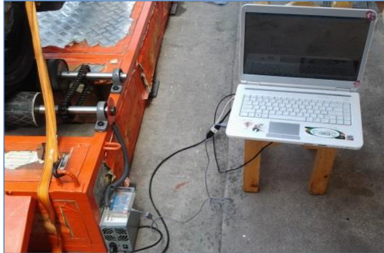
Figura 5. 11 Conexión de la PC al banco dinamométrico
