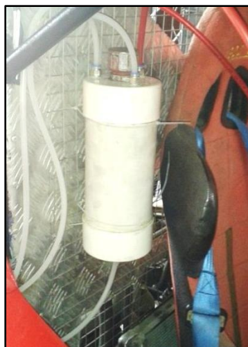
Figura 4.4 Fijación del depósito y burbujeador
