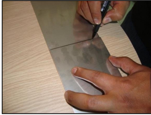
Figura 3.2 Señalado y corte de las placas
