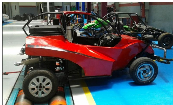
Figura 5.1 Pruebas en el dinamómetro de rodillos
