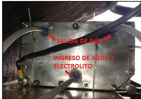
Figura 4.3 Fijación del generador del gas HHO
