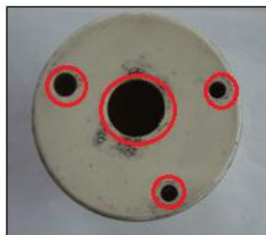
Figura 3.23 Tapón con orificios de 0,032 m, 0,008 m y 0,0095 m
