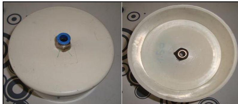
Figura 3.25 Parte inferior del depósito
