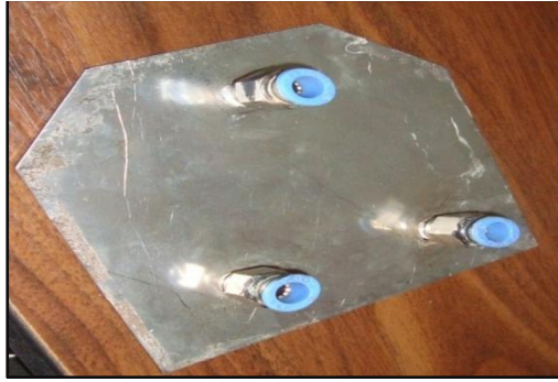
Figura 3.12 Placa frontal con los conectores rápidos
