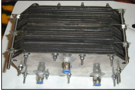
Figura 2.20 Celda generadora seca
