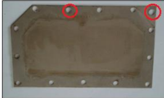
Figura 3.7 Placa positiva y negativa con perforaciones de sujeción y de alimentación de energía
