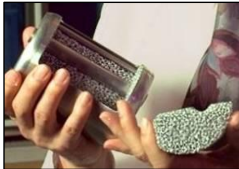
Figura 2.13 Pequeña unidad de almacenamiento de hidruros metálicos
