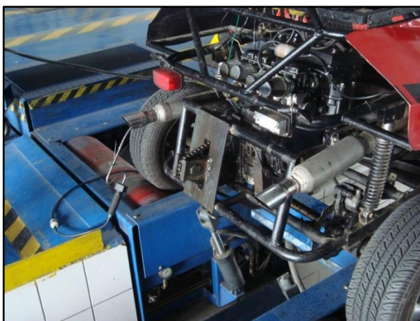
Figura 5.10 Medición de gases contaminantes
