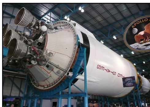
Figura 2.12 Depósito criogénico de hidrógeno del Saturno V
