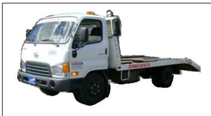
Figura: 2. 2. Plataforma con caída y rampas desmontables.
