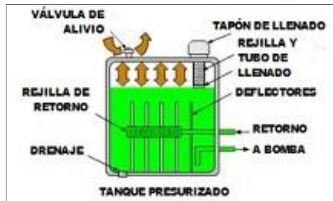
Figura: 2. 14. Deposito hidráulico
