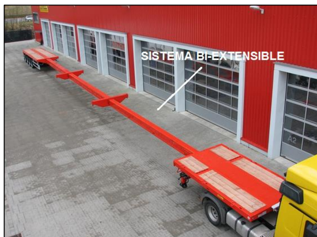
Figura: 2. 7. Plataforma biextensible.
