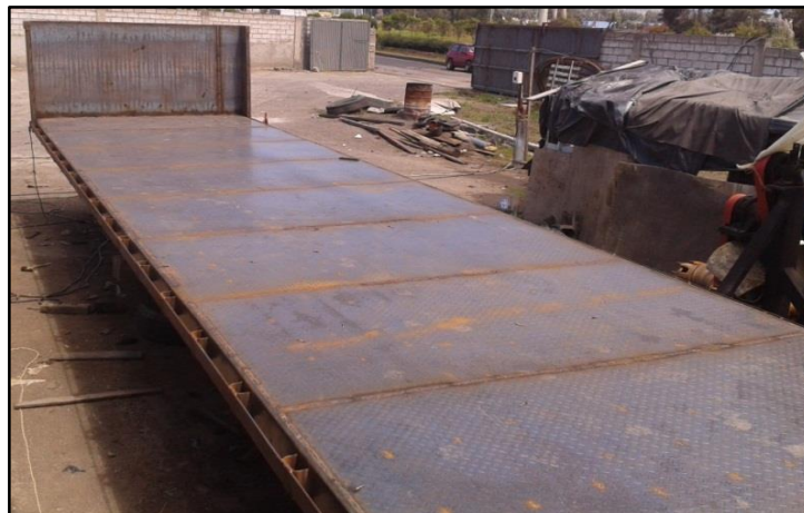
Figura 5.20 Plancha corrugada, vista exterior
