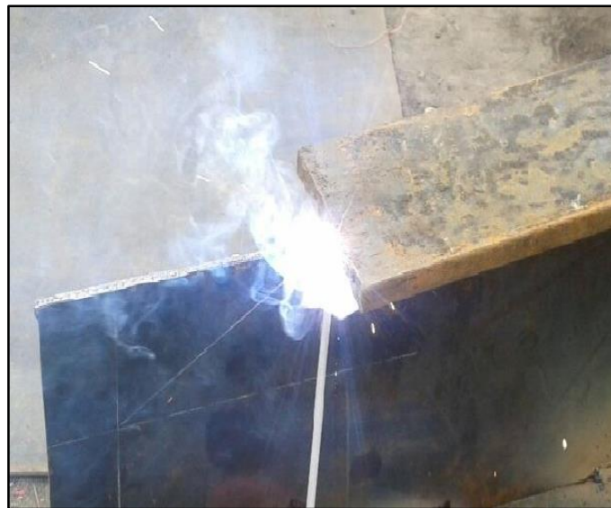
Figura 5.27 Soldadura de platina superior de larguero
