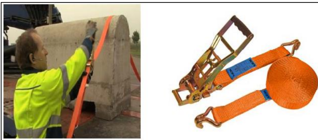
Figura 3.7 Cintas de trincaje
