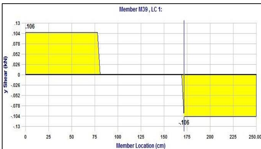
Figura 4.25 Hipótesis 3, análisis de la fuerza cortante en el travesaño con respecto al eje Y
