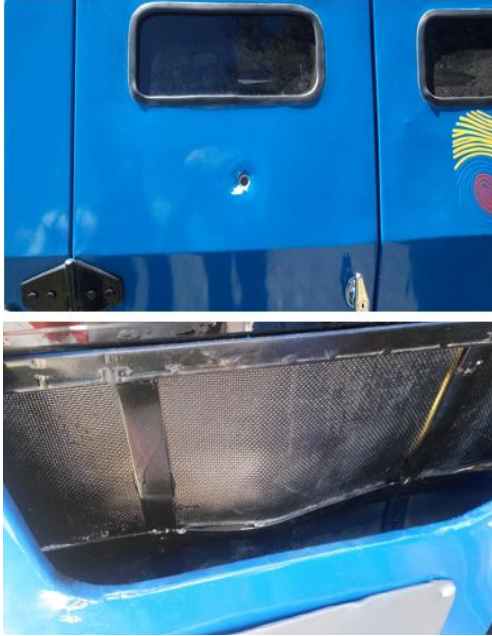
Figura 21: Prueba puerta blindada
