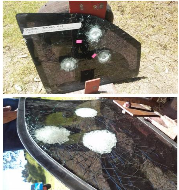
Figura 19: Resultados de la prueba vidrio blindado
