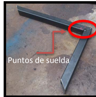
Figura 6. Perfiles unidos con solda TIG
