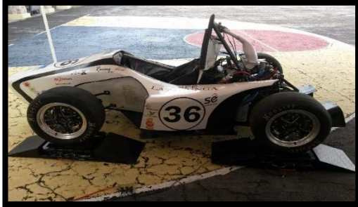
Figura 20. Pruebas de pesaje – Monoplaza FESPE
