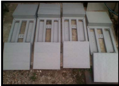
Figura 8. Estructuras con la capa de pintura de fondo
