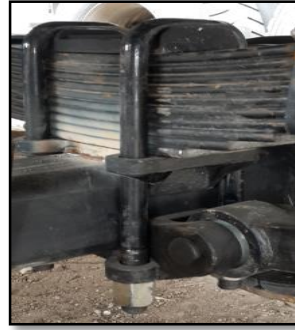
Figura 4. Eje sujetado a las ballestas.
