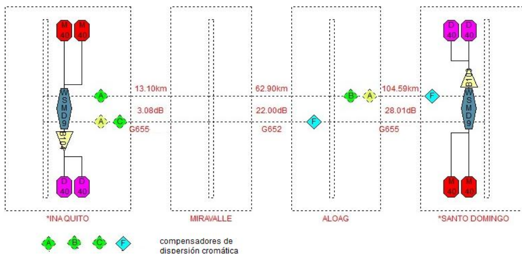
Figura 45. Configuración de DCM en enlaces Iñaquito-Aloag-Santo Domingo
