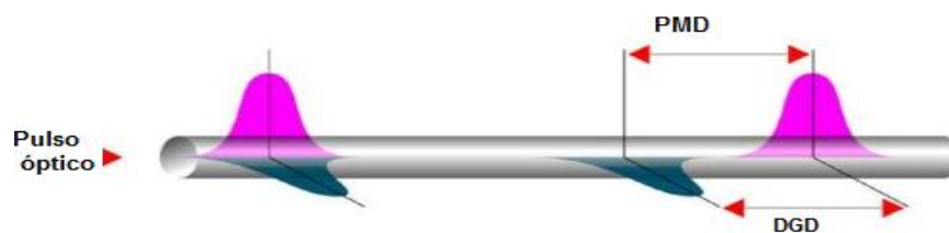
Figura 46. Efecto PMD en la fibra óptica
