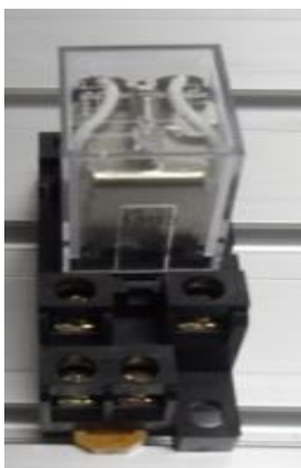
Figura 3. 25. Contactor de 24V
