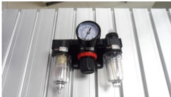
Figura 3. 38. Unidad de mantenimiento DANFOSS
