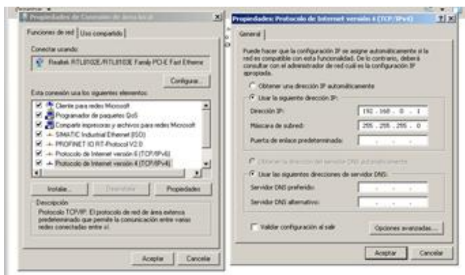
Figura 4. 20. Asignación de una dirección IP y submáscara de red para la PC
