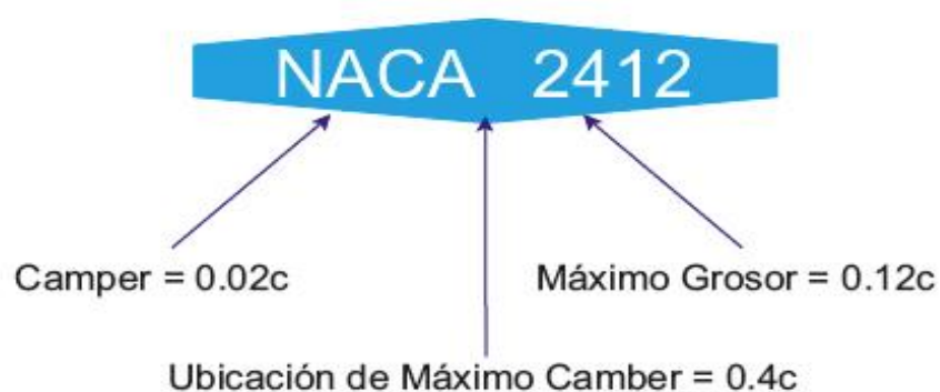
Figura 1.3 NACA de 4 dígitos. Fuente: (Paz, 2013)
