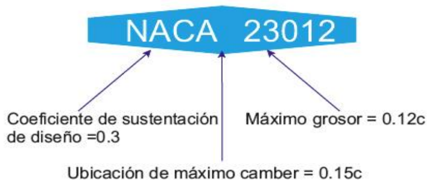
Figura 1.4 NACA de 5 dígitos.
