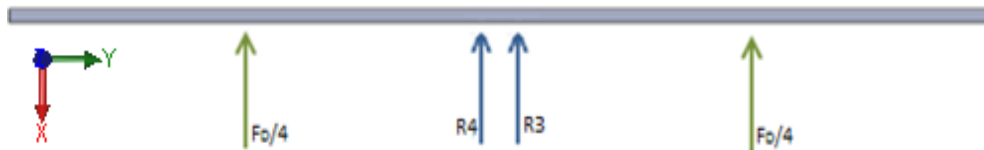
Figura 3.8 Diagrama de fuerzas que actúan sobre el ala (Vista frontal – Eje Y)
