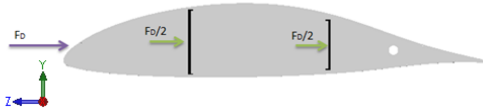
Figura 3.7 Diagrama de fuerzas que actúan sobre el ala (Vista lateral – Eje Y)
