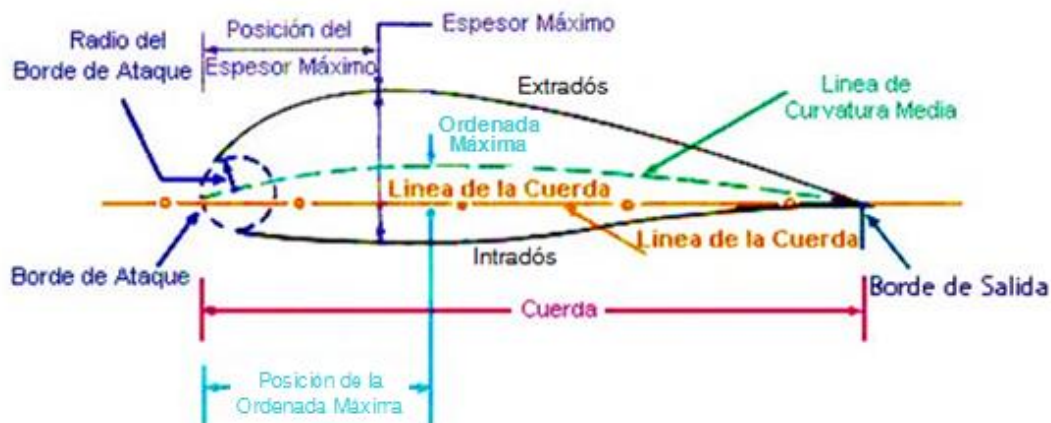
Figura 1.2 Terminología de un perfil alar.
