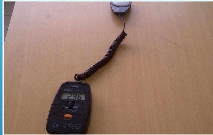
El luxómetro está colocado en la parte superior del pupitre de donde se obtendrá los datos de la luminancia de las lámparas que se encuentran dentro del aula.
