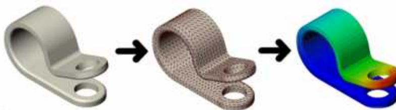
Figura 2.28. Proceso de simulación FUENTE (help.solidworks, 2015)
