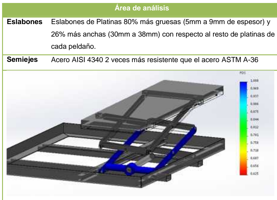
Figura 4.13. Resultados del factor de seguridad 2
