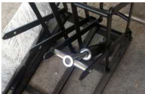
Figura 6.11. Ensamble de los semiejes
