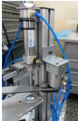
Figura 5.12 Estación de verificación y expulsión.
