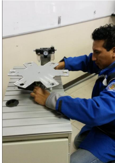
Figura 5.8 Montaje de los soportes del módulo didáctico.
