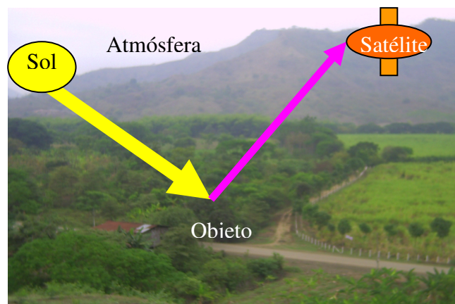
Figura 3. Principio de Teledetección
