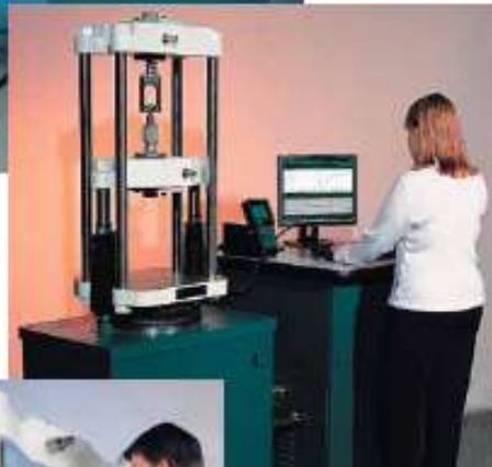
Fig. 6. Típica Super "L" 60,000 lbf (300kN) con ordenador opcional y software Tinius Olsen Horizon
