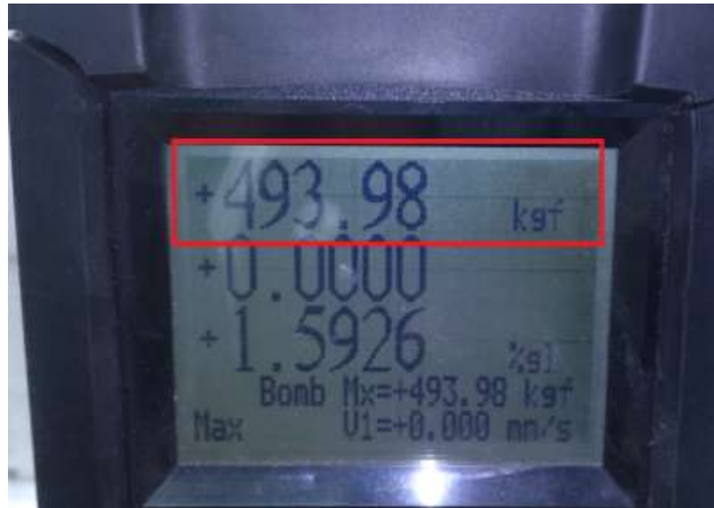
Figura 3.13. Representación de la carga máxima en el controlador manual de la máquina
