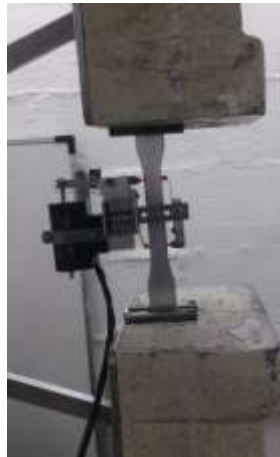
Figura 3.11. Representación gráfica del montaje de la probeta en la máquina universal y su extensómetro eléctrico
