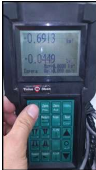
Figura 3.1. Representación gráfica de enceramiento de la fuerza en el controlador manual
