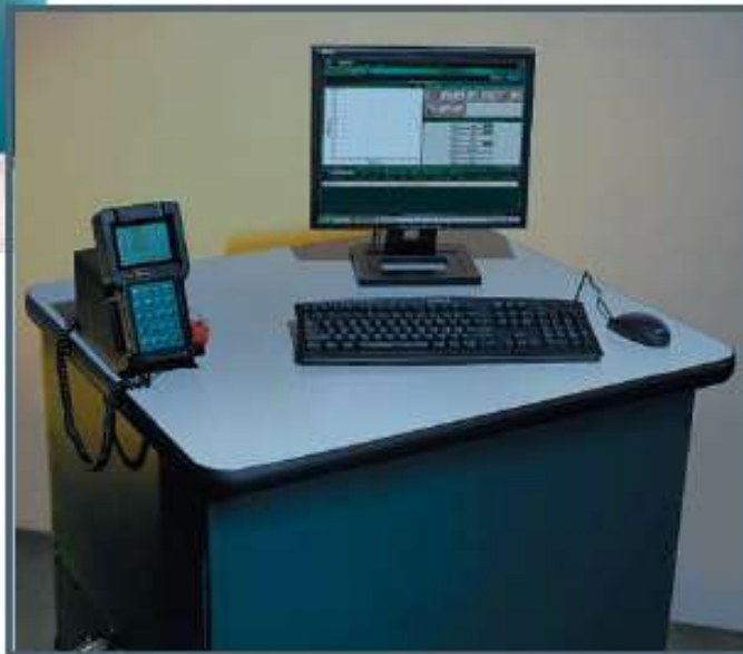
Fig. 4. Super "L" consola con controlador manual y ordenador opcional.
