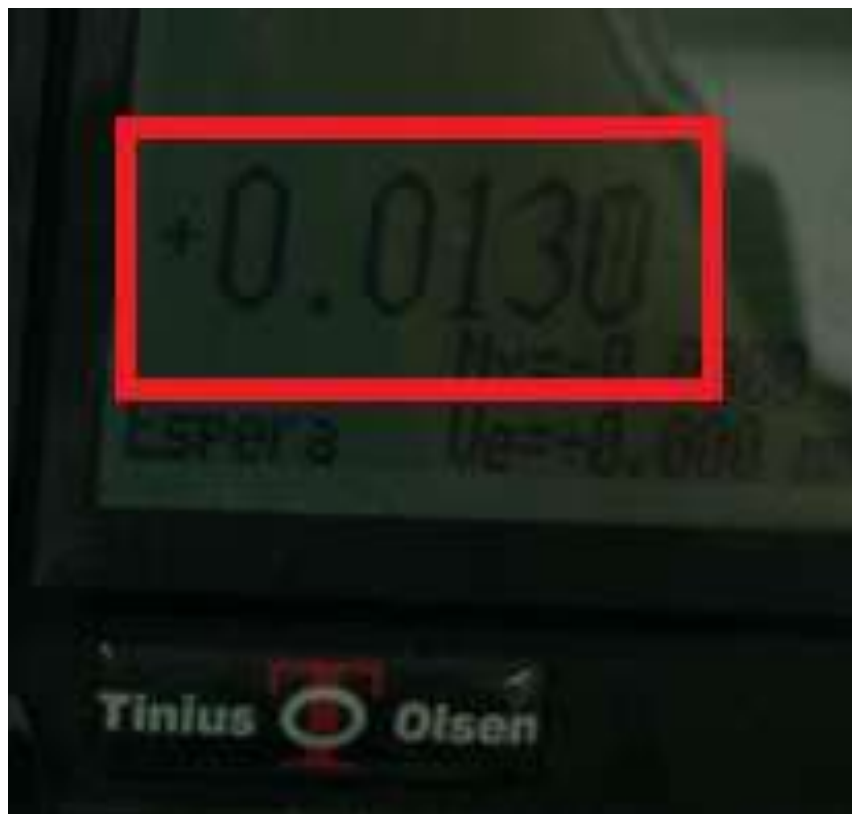
Figura 3.5. Representación gráfica de enceramiento de la deformación en el controlador manual
