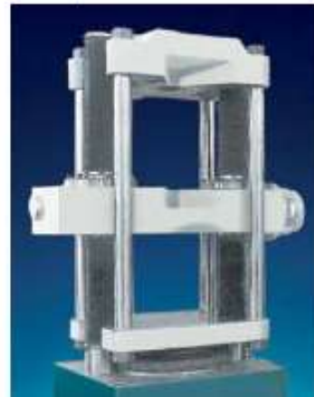
Fig. 8. Típica estándar Super "L" con marco de ensayos con travesaños frontales semi abiertos de 400,000 lbf (2,000kN)
