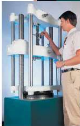
Fig. 6. Típica Super "L" 60,000 lbf (300kN) con ordenador opcional y software Tinius Olsen Horizon
