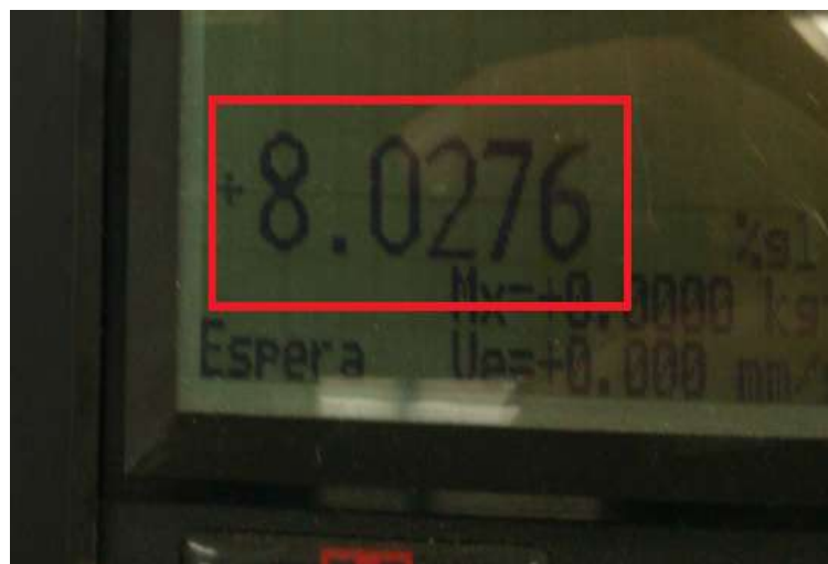
Figura 3.7. Representación gráfica de la deformación al 8,0276% del controlador manual
