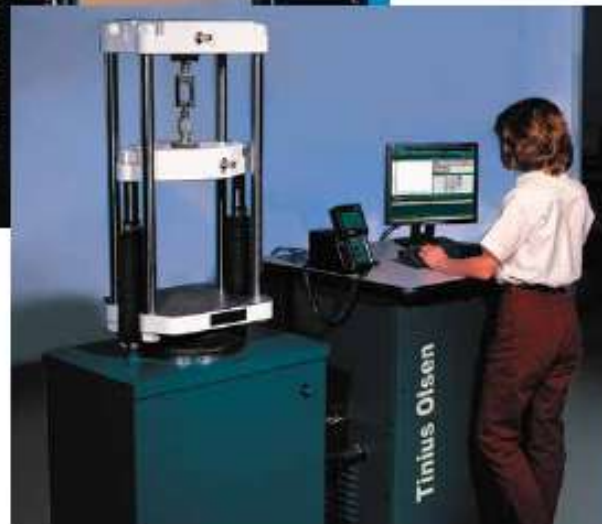
Fig. 2. Típica Super "L" 60,000 lbf (300kN) con controlador manual y sistema opcional de ordenador
