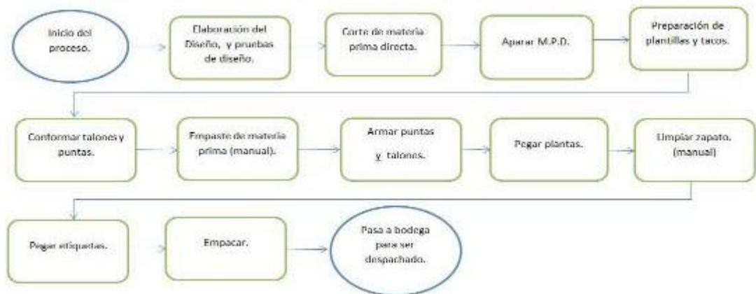
**Figura 2. 10: Diagrama de Flujo de la Elaboración de Calzado en Blessed.**
