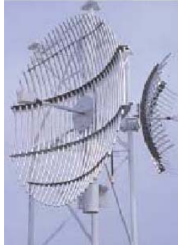
Figura. 2. 12. Antena Tipo Rejilla
