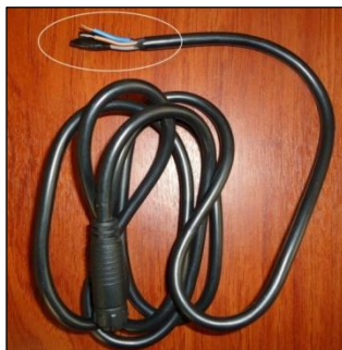
Figura 4.104 Cable de AC del Gateway PLC.
