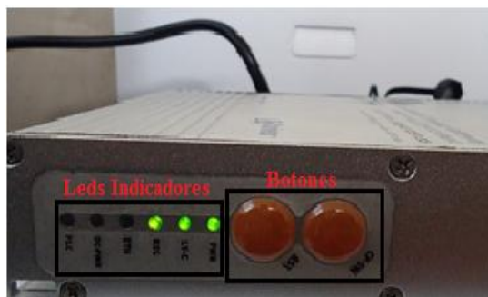
Figura 4.110 Leds indicadores del Gateway PLC.
