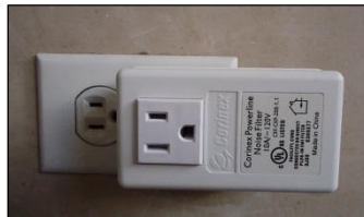
Figura 4.114 Conexión a la toma de corriente del filtro.
