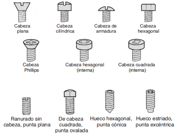
Figura 1. 13 Estilo de cabezas disponibles en tornillos, pernos y prisioneros
