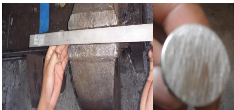
Figura 4. 1 Platina y tapa pulida con velocidad baja de la banda transportadora respectivamente
