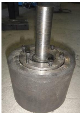
Figura 3. 4 Rodillo motriz de los sistemas
