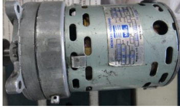
Figura 1. 17 Motor monofásico de baja velocidad y alto torque
