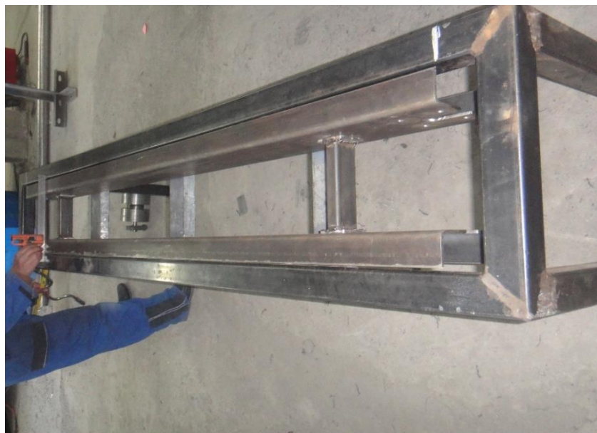
Figura 3. 6 Soporte de la banda
