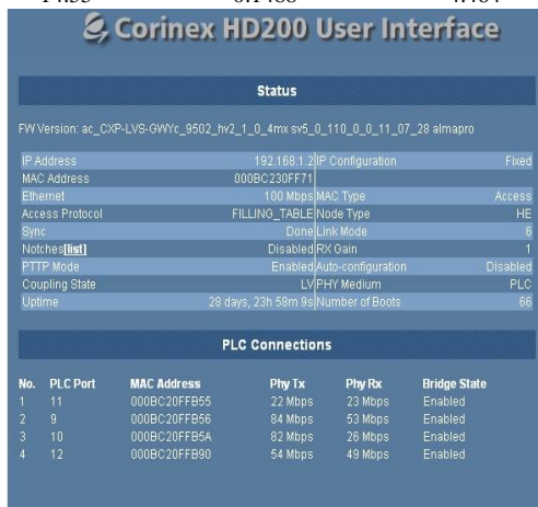
Figura IV.4 Velocidad a condiciones normales de carga (4 módems)
