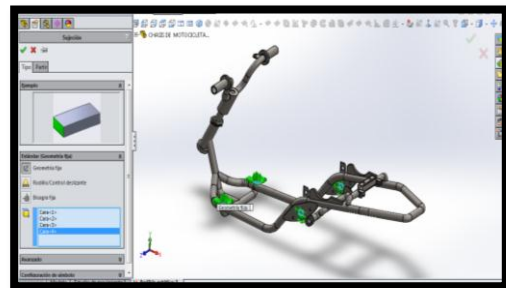
Figura 12. Fijaciones en el chasis tubular- motocicleta.
