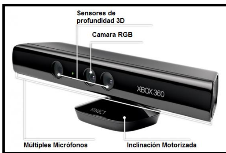
Figura 1.8 Componentes de Hardware del Kinect
