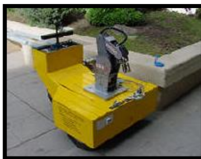
Figura 1.23 Sistema autónomo robot móvil más brazo robótico
