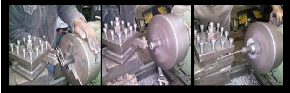
Figura 4.14 Maquinado del eje.
