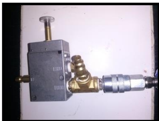
Figura 4.9 Adaptación de la electroválvula.
