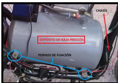
Figura 4.4 Fijación del depósito de baja presión.
