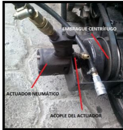
Figura 4.17 Implementación del actuador neumático.
