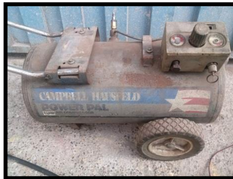
Figura 4.3 Depósito de baja presión.
