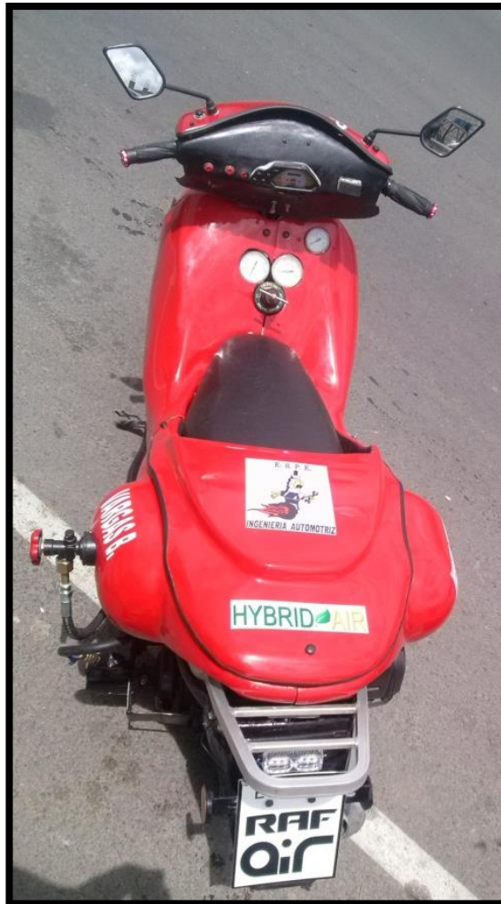
Figura 4.25 Prototipo de motocicleta con sistema híbrido de propulsión.
