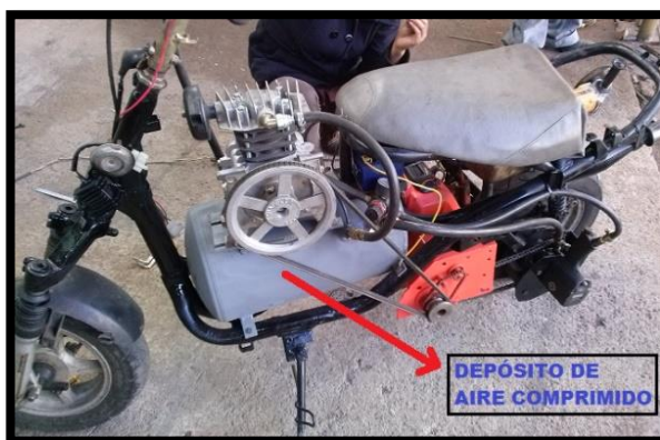
Figura 2.19 Depósito de aire comprimido a baja presión.
