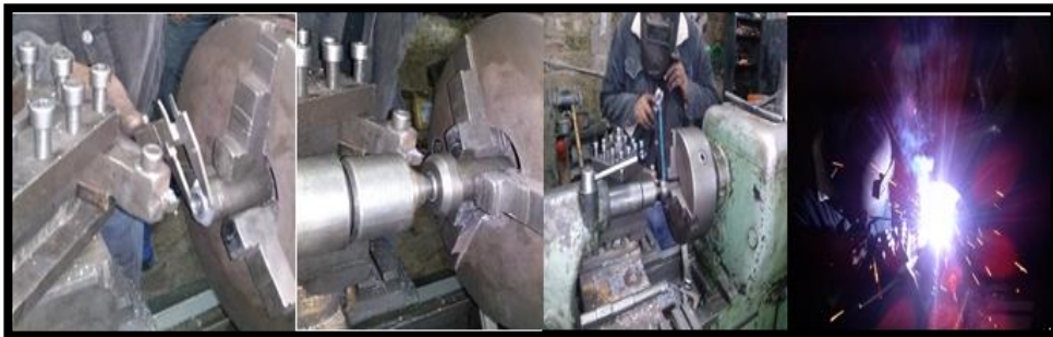
Figura 4.15 Suelda de las partes (1) y (2).
