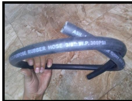
Figura 4.11 Tubería de baja presión.
