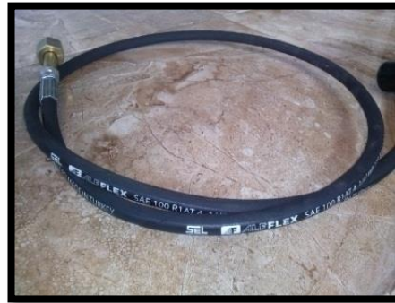
Figura 4.10 Tubería Parker 3/8" de 3763 PSI de presión máxima.
