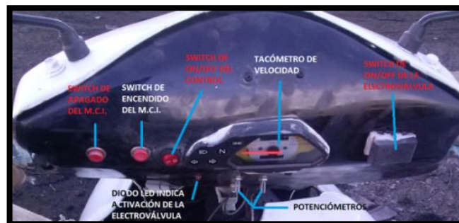
Figura 4.23 Tablero de componentes electrónicos.
