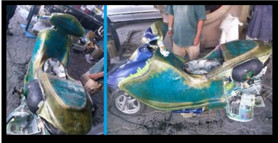
Figura 4.24 Diseño en fibra de vidrio de la carcasa de la motocicleta.
