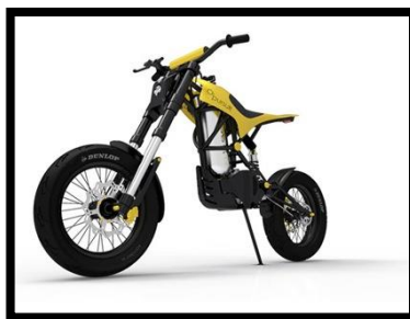
Figura 2.1 Motocicleta con motor de aire comprimido.
