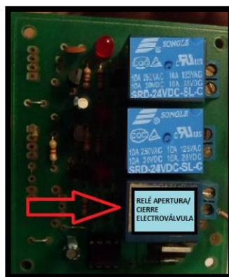
Figura 3.24 Relé de apertura y cierre de la electroválvula.
