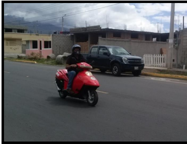
Figura 4.28 Pruebas de funcionamiento con velocidad máxima de 15 km/h.
